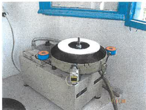
Σχήμα 4.19 Το φίλτρο τοποθετημένο στο δοχείο εκχύλισης.
