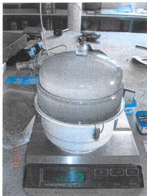
Σχήμα 4.15 Το πυκνόμετρο μαζί με το δείγμα, γεμάτο νερό.
