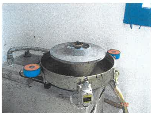
Σχήμα 4.20 Το δοχείο εκχύλισης σφραγισμένο στον εκχυλιστή.
