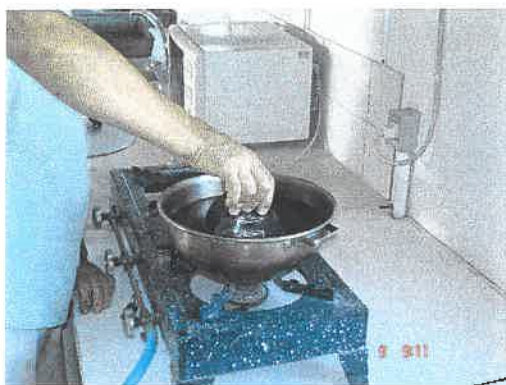
Σχήμα 4.34 Επικάλυψη δοκιμίου με παραφίνη.
