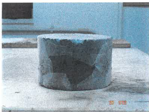
Σχήμα 4.32 Επικαλυμμένο δοκίμιο με παραφίλμ. (α)
