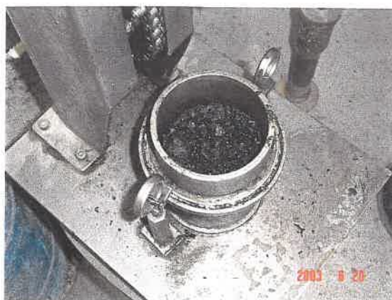
Σχήμα 4.9 Το ασφαλτόμιγμα τοποθετημένο στην μήτρα.
