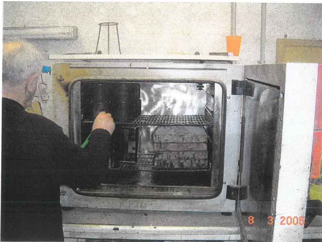
Σχήμα 4.5 Οι μήτρες και τα αδρανή μέσα στο φούρνο, έτοιμα για χρήση και παρασκευή.
