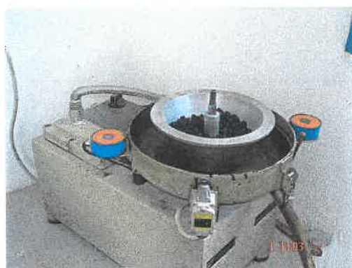
Σχήμα 4.14 Το δοχείο εκχύλισης με το ασφαλτόμιγμα τοποθετημένο στον εκχυλιστήρα.
