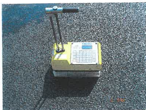
Σχήμα 5.5 Η συσκευή troxler αυτορυθμίζεται πάνω σε ειδική επιφάνεια.
