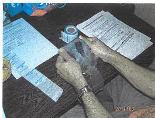
Σχήμα 4.29 Επικάλυψη δοκιμίου με παραφίλμ (γ)
