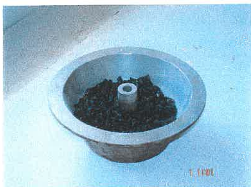
Σχήμα 4.13 Το δοχείο εκχύλισης με το δείγμα ασφαλτομίγματος.
