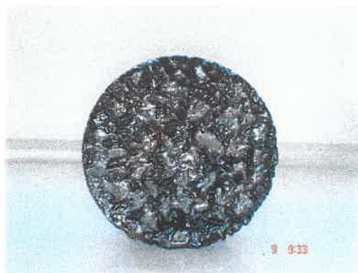
Σχήμα 4.35 Δοκίμιο επικαλυμμένο με παραφίνη.
