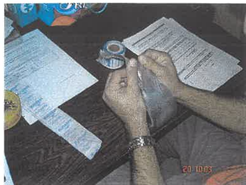
Σχήμα 4.31 Επικάλυψη δοκιμίου με παραφίλμ (δ)
