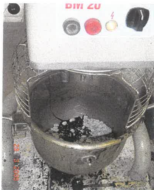
Σχήμα 4.6 Τοποθέτηση αδρανών και ασφάλτου στον αναδευτήρα προς μίξη.
