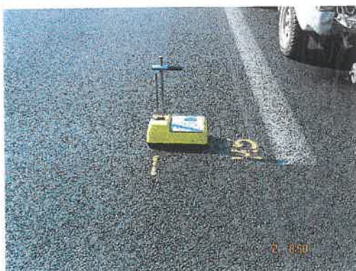
Σχήμα 5.6 Η συσκευή troxler παίρνει μέτρηση.
