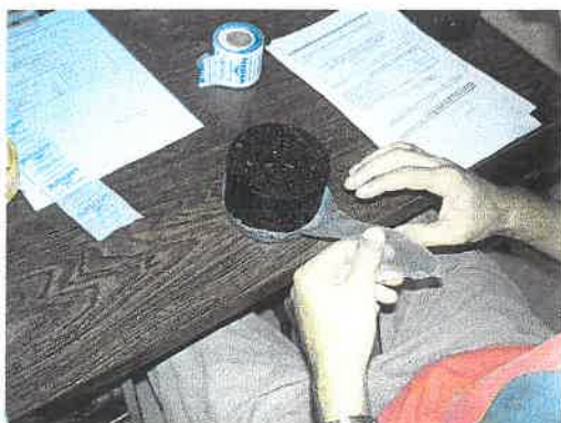
Σχήμα 4.28 Επικάλυψη του δοκιμίου με παραφίλμ (α).
