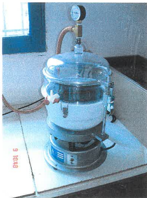
Σχήμα 4.14 Το δείγμα τοποθετείται στο πυκνόμετρο πριν την εφαρμογή του κενού.
