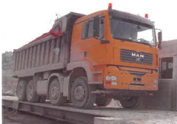
Εικόνα 5-2: Προσδιορισμός στατικού βάρους σε γεφυροπλάστιγγα
