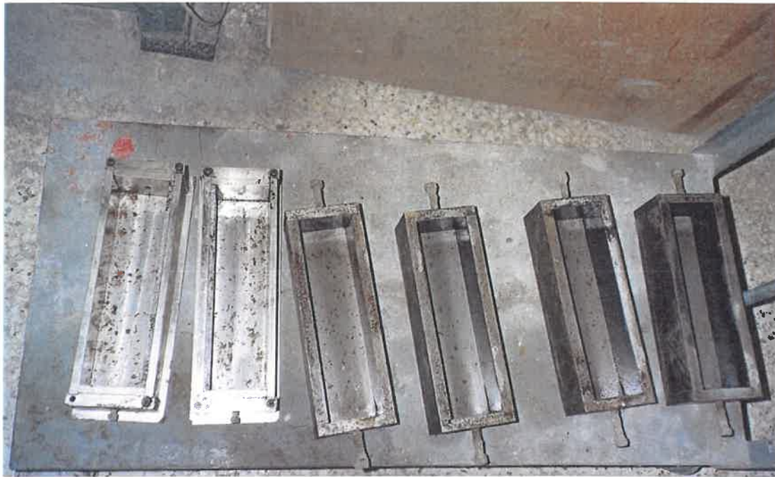
ΦΩΤΟΓΡΑΦΙΑ 4.3.4. ΛΑΔΩΜΕΝΕΣ ΜΗΤΡΕΣ ΕΤΟΙΜΕΣ ΝΑ ΤΟΠΟΘΕΤΗΘΕΙ ΤΟ ΜΙΓΜΑ
