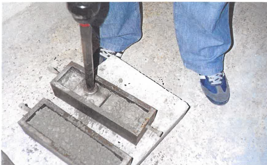
ΦΩΤΟΓΡΑΦΙΑ 4.3.5. ΣΥΜΠΥΚΝΩΣΗ ΟΡΘΟΓΩΝΙΚΩΝ ΔΟΚΙΜΙΩΝ ΜΕ ΔΟΝΗΤΙΚΗ ΗΛΕΚΤΡΟΣΦΥΡΑ
