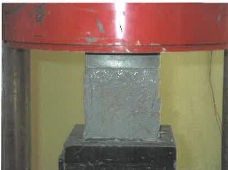
φωτογραφία 3 : Δοκιμή σε θλίψη κυβικού δοκιμίου
