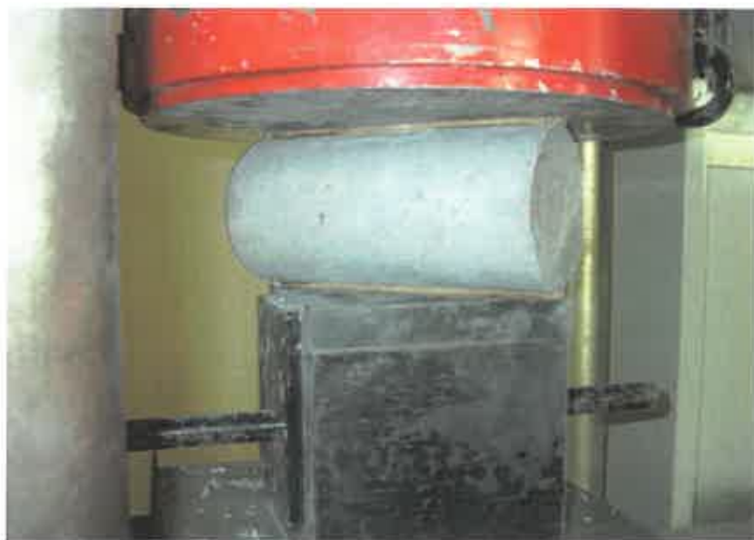
Φωτογραφία 4 : Κυλινδρικό δοκίμιο λίγο πριν υποβληθεί σε εφελκυσμό από διάρρηξη
