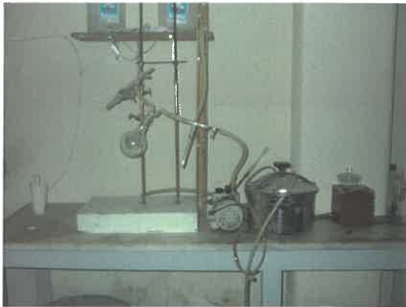
Φωτογραφία 5 : Πειραματική συσκευή δημιουργίας υποπίεσης σε δοκίμια από σκυρόδεμα.
