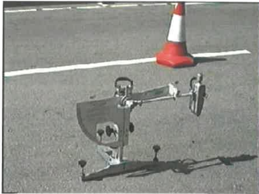
Σχήμα 2.8 Μέτρηση Αντίστασης σε Ολίσθηση με το Βρετανικό Εκκρεμές
