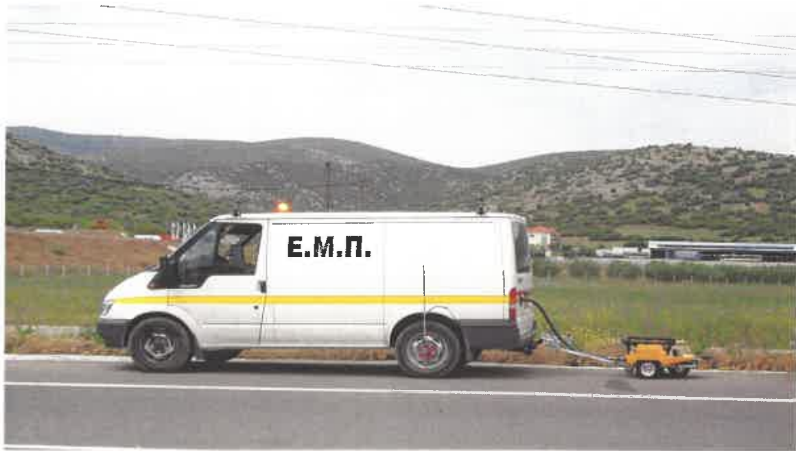
Σχήμα 3.3 Μέτρηση ολισθηρότητας με Grip Tester
