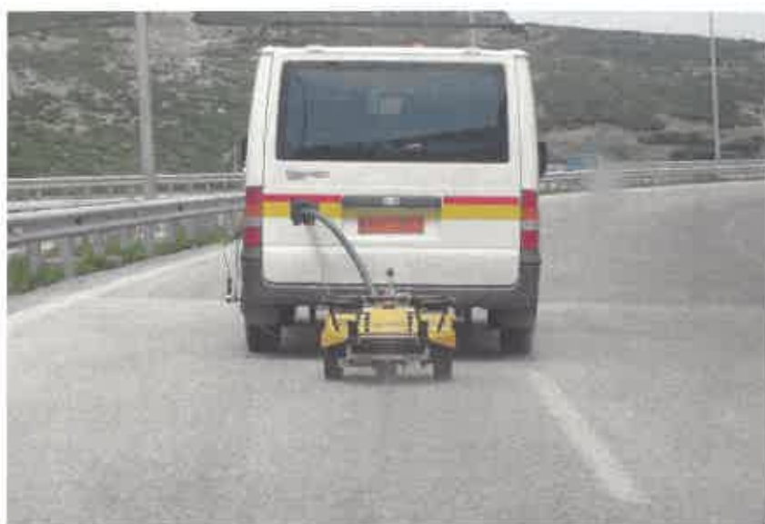
Σχήμα 3.2 Πραγματοποίηση μέτρησης με το Grip Tester σε τμήμα της Εγνατίας Οδού
