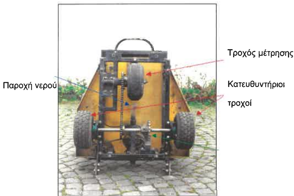
Σχήμα 3.4 Επισήμανση παροχής νερού στο Grip Tester
