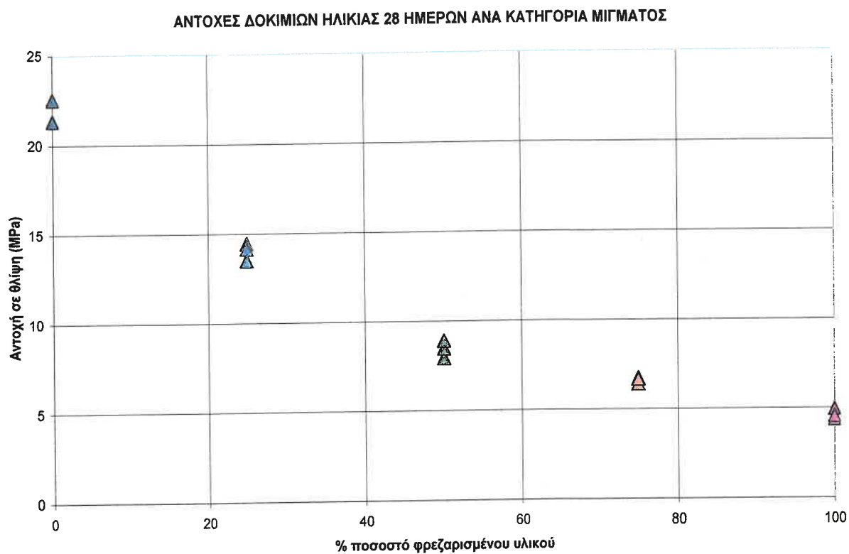
Σχ7.2, Αντοχές δοκιμών ηλικίας 28 ημερών συναρτήσει του % ποσοστού φρεζαρισμένου υλικού
