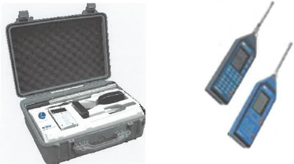
Εικόνα 3-4 – Κινητές μονάδες ηχομέτρησης (ηχόμετρα χειρός).
