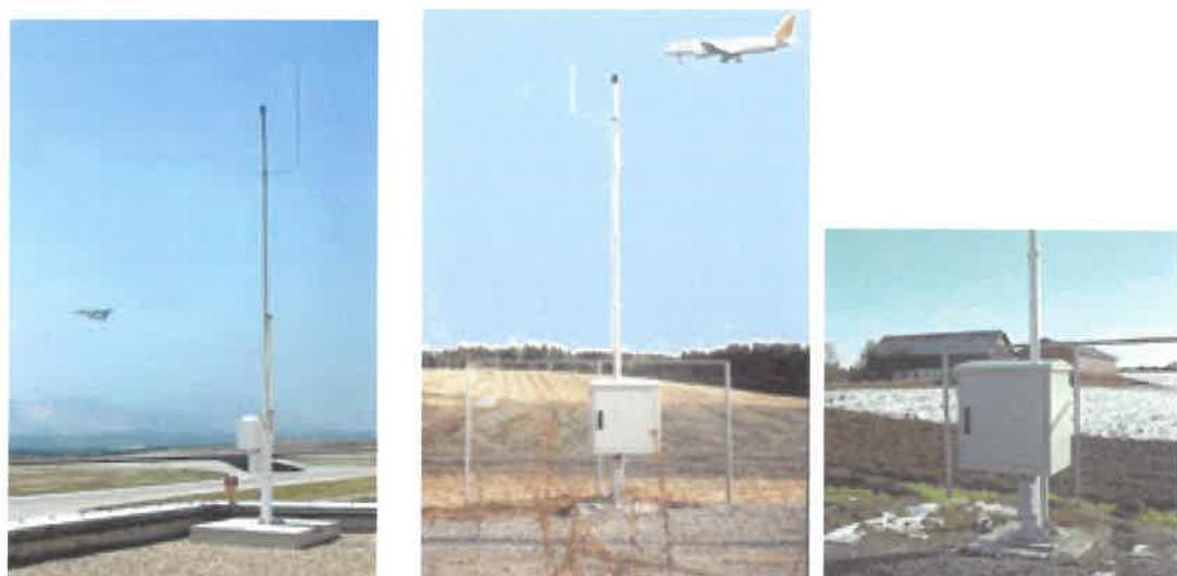
Εικόνα 3-5 – Σταθεροί σταθμοί ηχομέτρησης.
