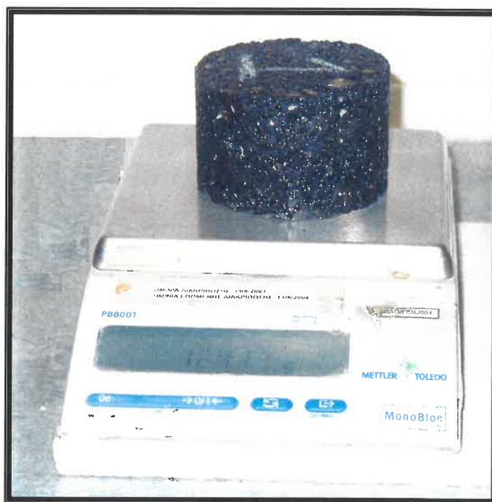
Εικόνα 2-9. Ζύγισμα δοκιμίου στον αέρα.
