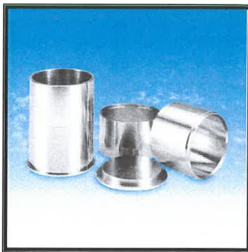
Εικόνα 2-6. Μήτρες που χρησιμοποιούνται για την παρασκευή δοκιμίων.
