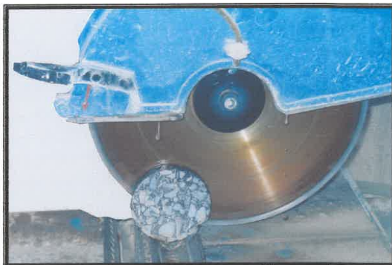
Εικόνα 4-2. Κοπή δοκιμίου με κυκλικό δίσκο κοπής από διαμάντι.
