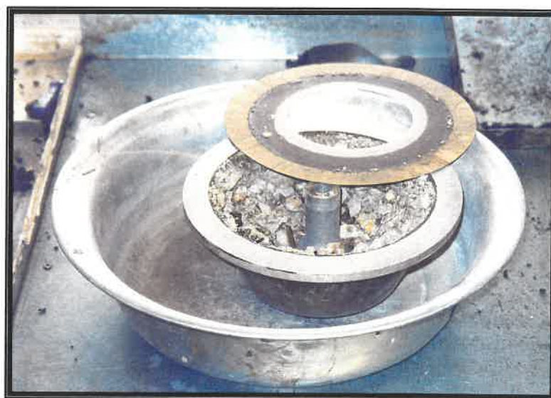
Εικόνα 2-5. Δείγμα μετά την δοκιμή μέσα στον υποδοχέα και φίλτρο.
