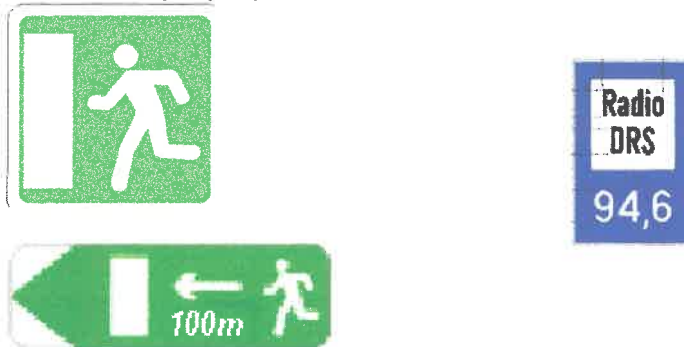
Σχήμα 2.6 : Σήμανση διαφυγών εξόδου και ραδιοφωνικής ενημέρωσης στις σήραγγες.
