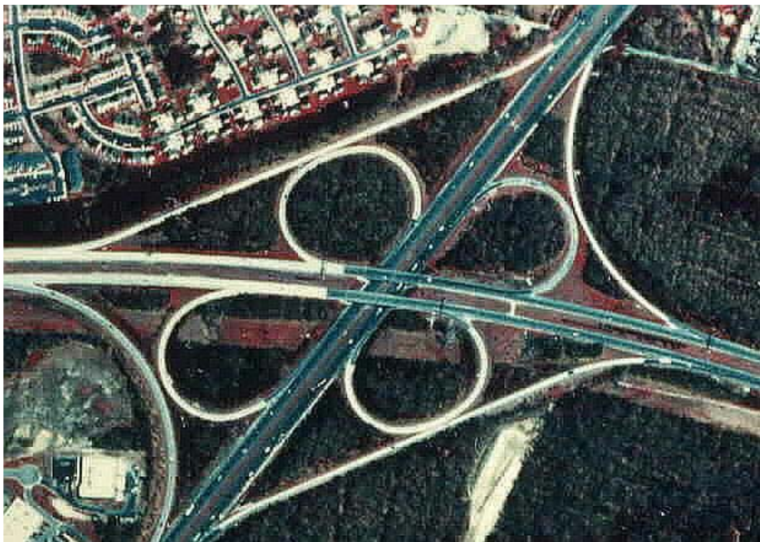
Φωτογραφία 4 : Ανισόπεδος κόμβος μορφής πλήρους τετράφυλλου στο Τορόντο του Καναδά (πηγή : διαδίκτυο - www.math.toronto.edu/.../Interchange/CloverLeaf.html )
