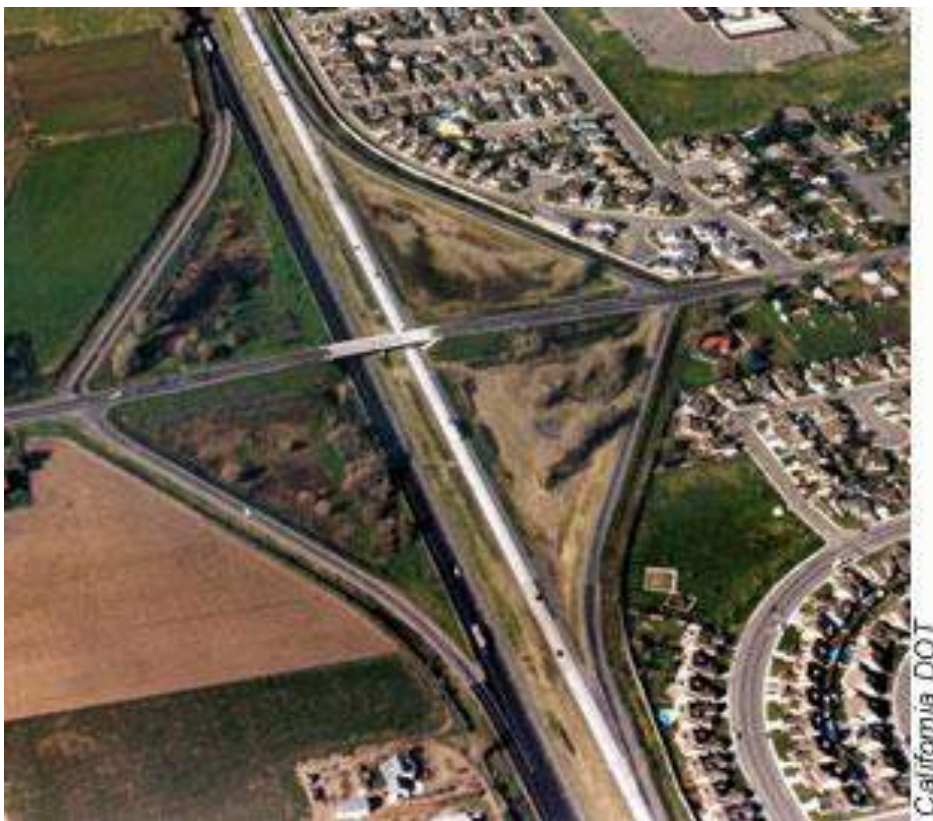
Ψηφιακή εικόνα 1 – Ανισόπεδος κόμβος μορφής ρόμβου
