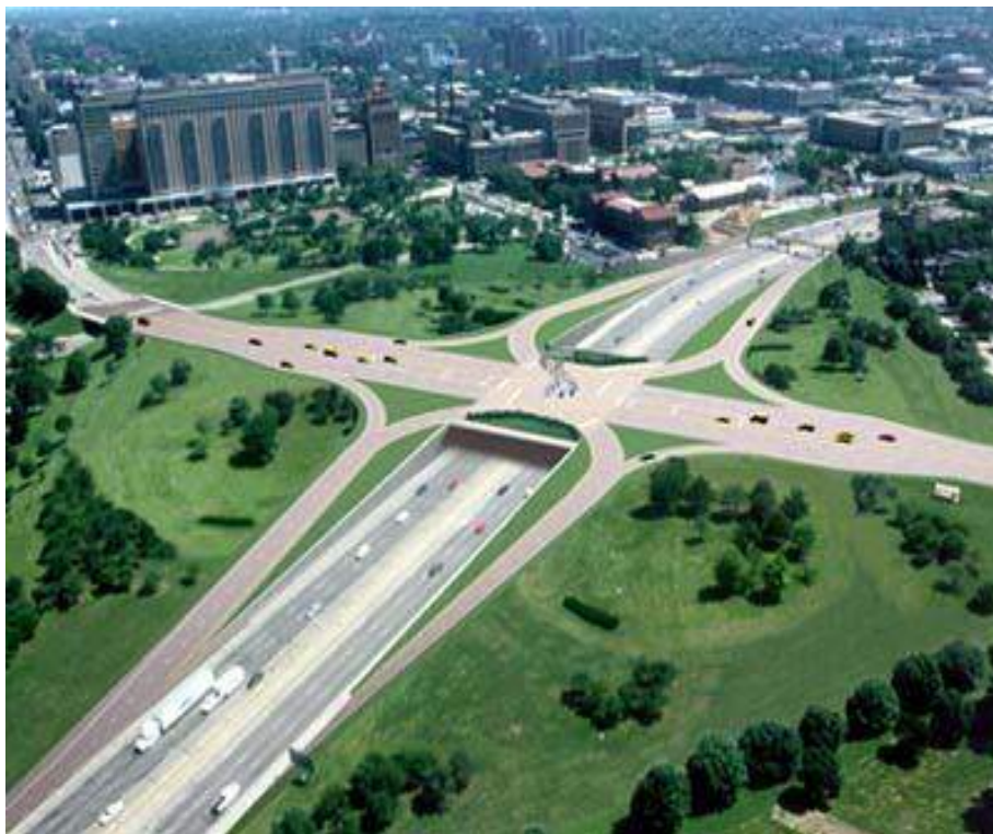
Ψηφιακή εικόνα 2 – Ανισόπεδος κόμβος μορφής ρόμβου
