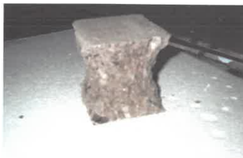
Εικόνα 2.3.4: Δοκίμιο έπειτα από δοκιμή ισοδύναμου κύβου (φαίνεται η επιφάνεια θραύσης).
