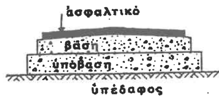
Σχήμα 1.1.2: Τομή ευκάμπτου οδοστρώματος
