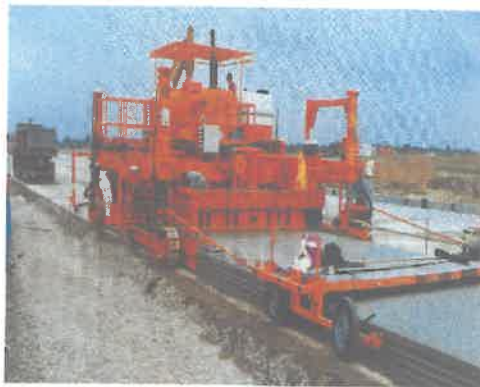
Εικόνες 1.8.6 - 1.8.7: Αυτοματοποιημένες διατάξεις ανακύκλωσης δύσκαμπτων οδοστρωμάτων [4]
