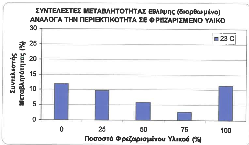
Σχήμα 3.2.8: Συγκριτικό διάγραμμα συντελεστών μεταβλητότητας μέτρων ελαστικότητας θλίψης σε σχέση με την περιεκτικότητα σε φρεζαρισμένο υλικό (διορθωμένο)
