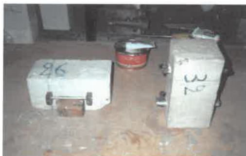
Εικόνα 2.3.5: Δοκίμιο κατά την τοποθέτηση ηλεκτρομηκυνσιομέτρων αντιστάσεως (LVDT) πριν από τη δοκιμή θλίψης πρίσματος.
