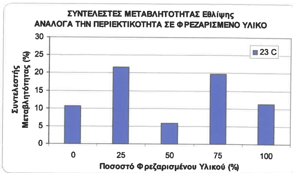
Σχήμα 3.2.7: Συγκριτικό διάγραμμα συντελεστών μεταβλητότητας μέτρων ελαστικότητας θλίψης σε σχέση με την περιεκτικότητα σε φρεζαρισμένο υλικό
