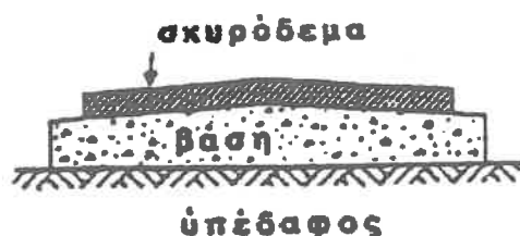
Σχήμα 1.1.3: Τομή δυσκάμπτου οδοστρώματος
