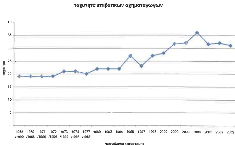
Διαγραμμα 2.1 στο οποίο διαφαινεται η εξελιξη των μεγιστων ταχυτητων των επιβατικων οχηματαγωγων που δραστηριοποιουνται στις ελληνικες θαλασσες ως προς το ετος κατασκευης τους.
