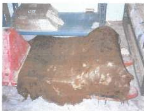
Φωτογραφία 5.7.3: Κάλυψη δοκιμίων με υγρή λαντάσα
