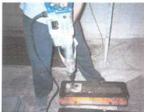
Φωτογραφία 5.6.1: Συμπύκνωση πρώτης στρώσης
