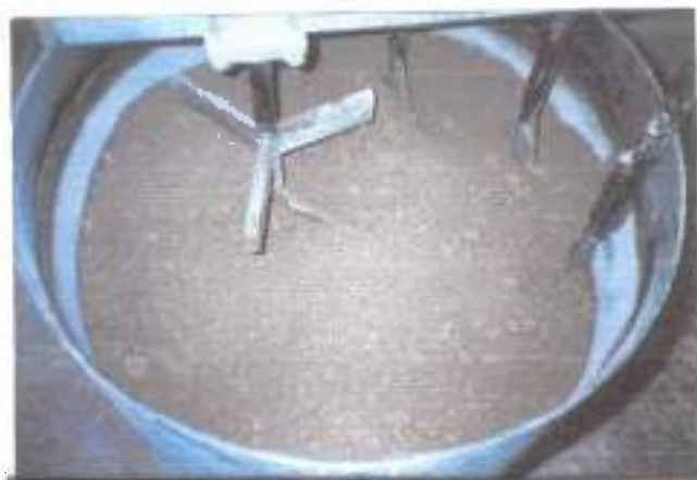
Φωτογραφία 5.5.2: Αναμικτήρας με το υλικό
