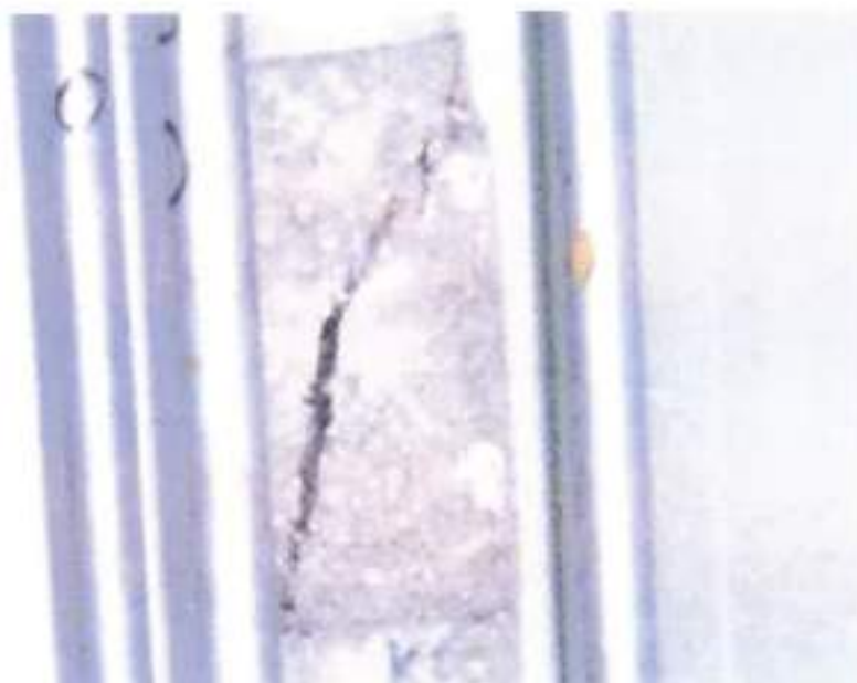
Εικόνα 9-2, Διατμητική αστοχία δοκιμίου
