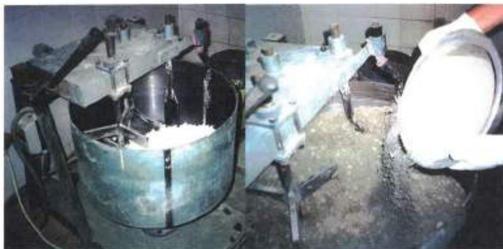
Εικόνα 6-1, Τοποθέτηση και ανάμιξη των υλικών στον αναμικτήρα
