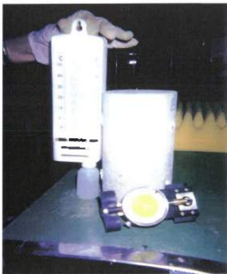
Εικόνα 7-5, Δοκίμιο το οποίο χρησιμοποιήθηκε για την δοκιμή συστολής ξήρανσης, όργανο DEMEC και όργανο μέτρησης θερμοκρασίας και υγρασίας
