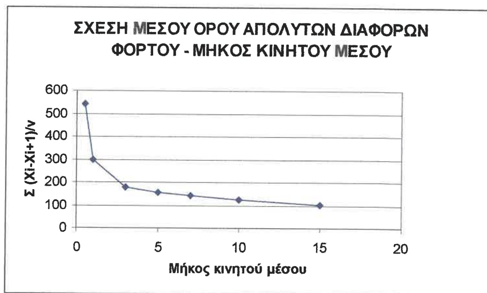
Σχήμα 7.2 : Σχέση μέσου όρου απόλυτων διαφορών φόρτου- μήκος κινητού μέσου
