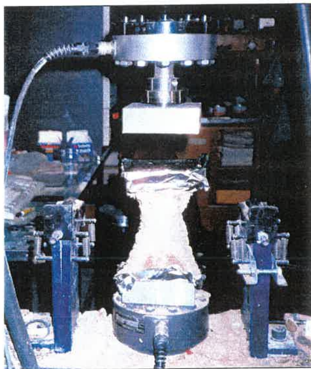
Εικόνα 4.3 Αστοχία πρίσματος σε θλίψη
