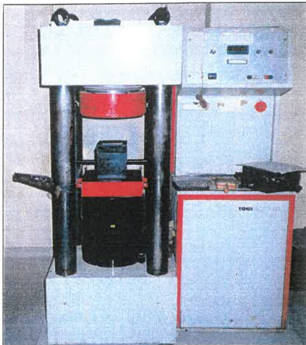
Εικόνα 5.1 Μηχανή θραύσης TONI PACT 3000
