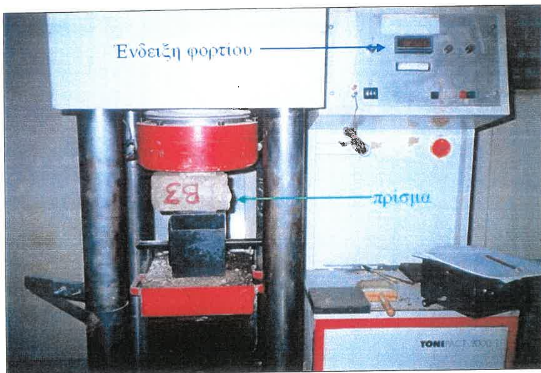
Εικόνα 6.1 Θλίψη πρίσματος σε ισοδύναμο κύβο
