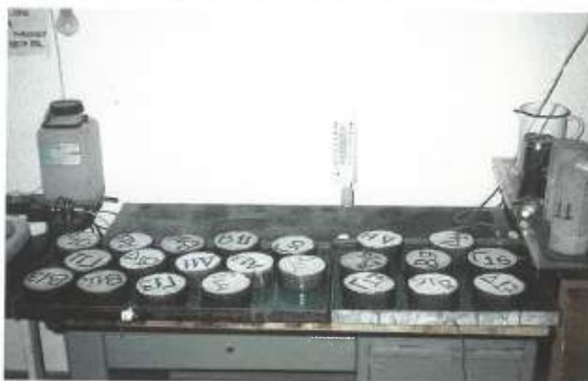
Φωτογραφία 7-4: Διάταξη των δοκιμίων της δοκιμής της υδαταπορρόφησης.
