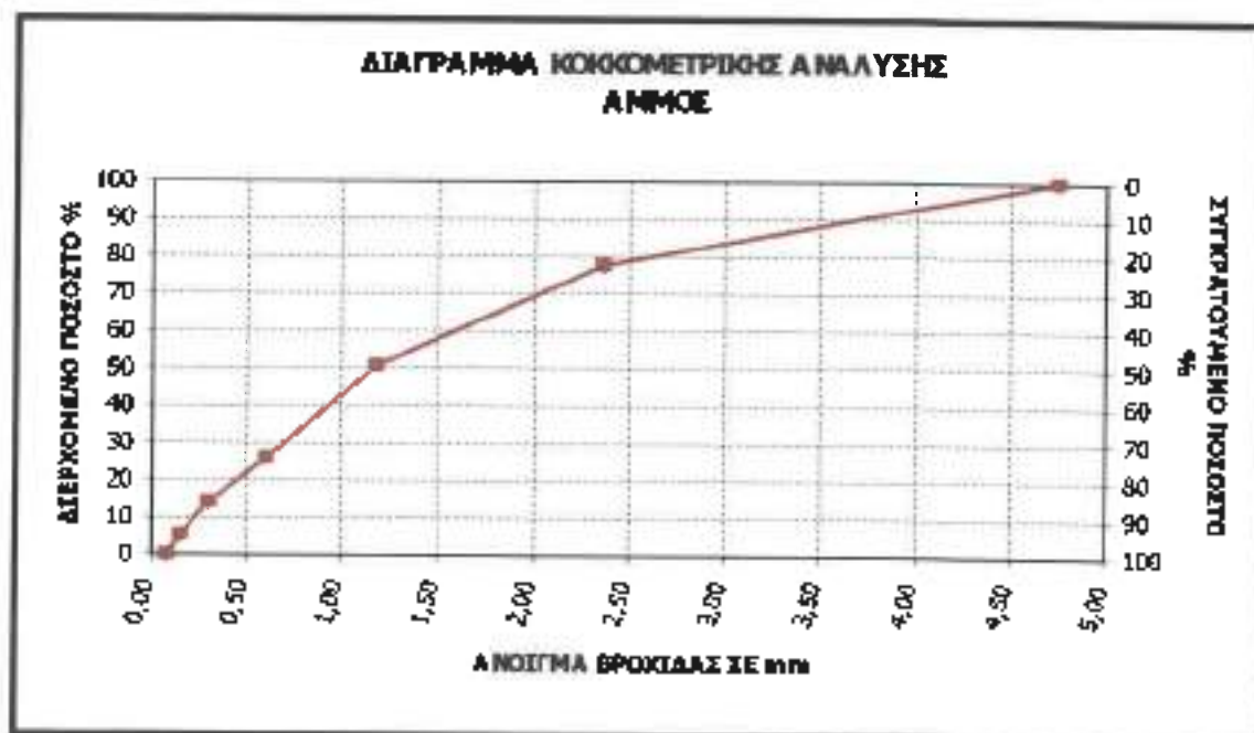
Σχήμα 7-3: Διάγραμμα κοκκομετρικής ανάλυσης άμμου.
