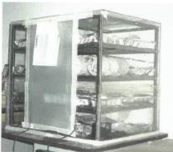
Φωτογραφία 7-1: Διάταξη των διαλυμάτων και των δοκιμών στο θάλαμο του NaCl.
