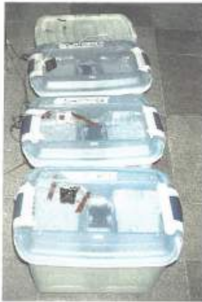
Φωτογραφία 7-2: Διάταξη των διαλυμάτων και των δοκιμίων σε θάλαμο KCl.
