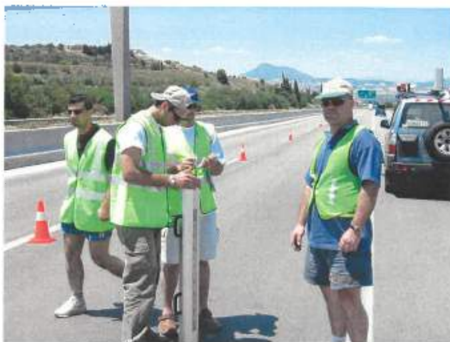
Σχήμα 7.6: Μετρήσεις με τη συσκευή LOADMAN
