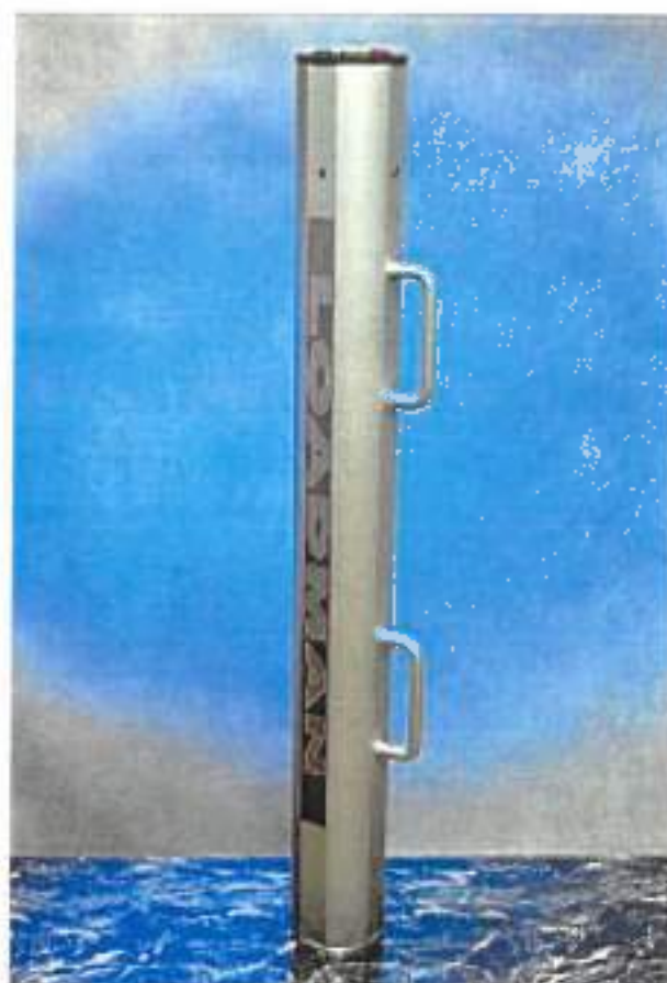
Σχήμα 4.8. Φωτογραφία της συσκευής LOADMAN [12]
