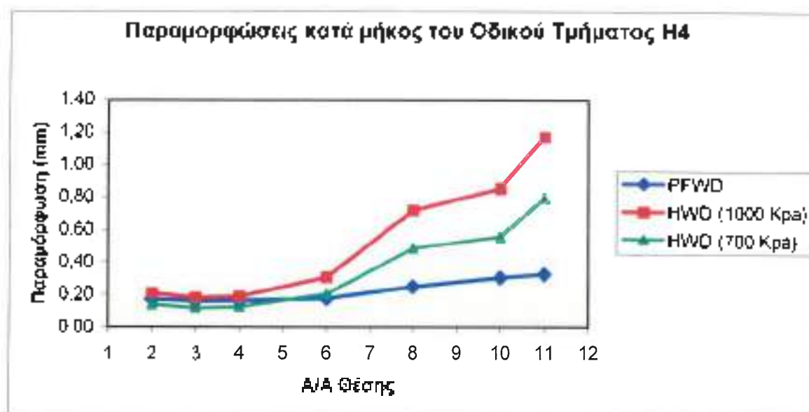
Σχήμα 13.6: Παραμορφώσεις κατά μήκος του τμήματος Η4 (Δίκτυο Χαλκιδικής)
