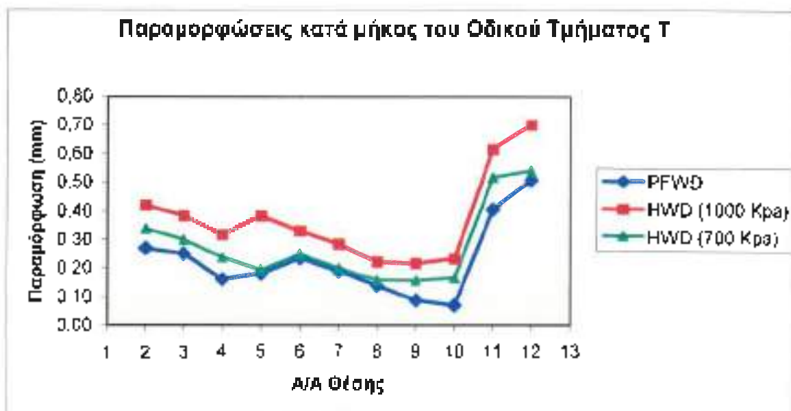
Σχήμα 13.3: Παραμορφώσεις κατά μήκος του τμήματος Τ (Δίκτυο Θεσσαλίας)
