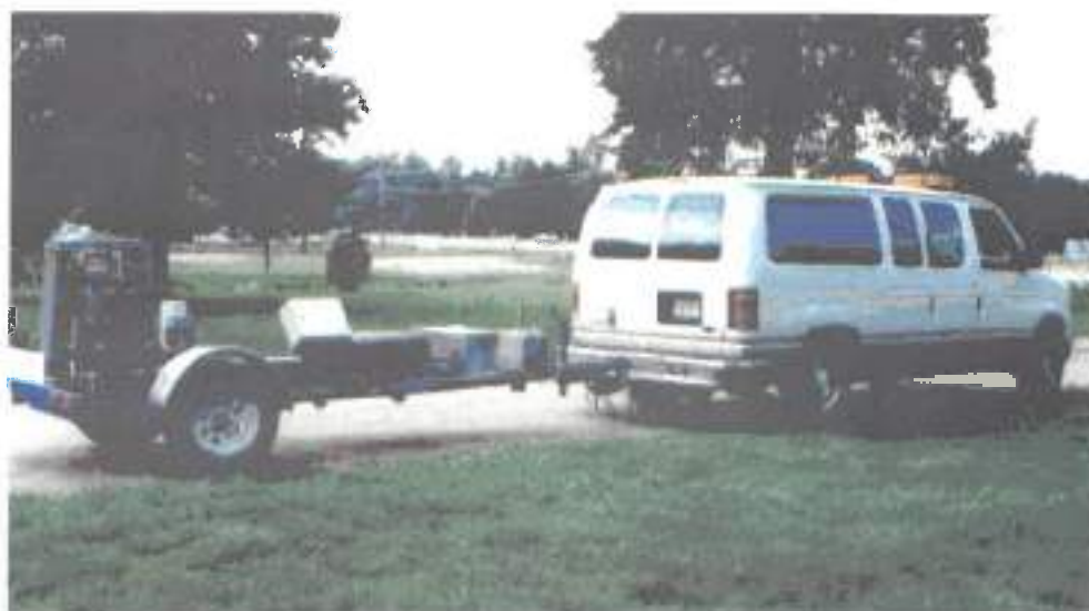
Σχήμα 3.6: Ρυμούλκηση ενός συμβατικού FWD ( www.wsdot.wa.gov/biz/mats/pavement/fwd.htm )
