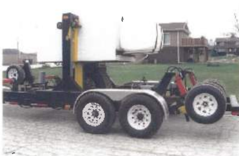
Σχήμα 2.9: Rolling Weight Deflectometer ( www.aepo.es/ausc/equip/fwdkf.htm )
