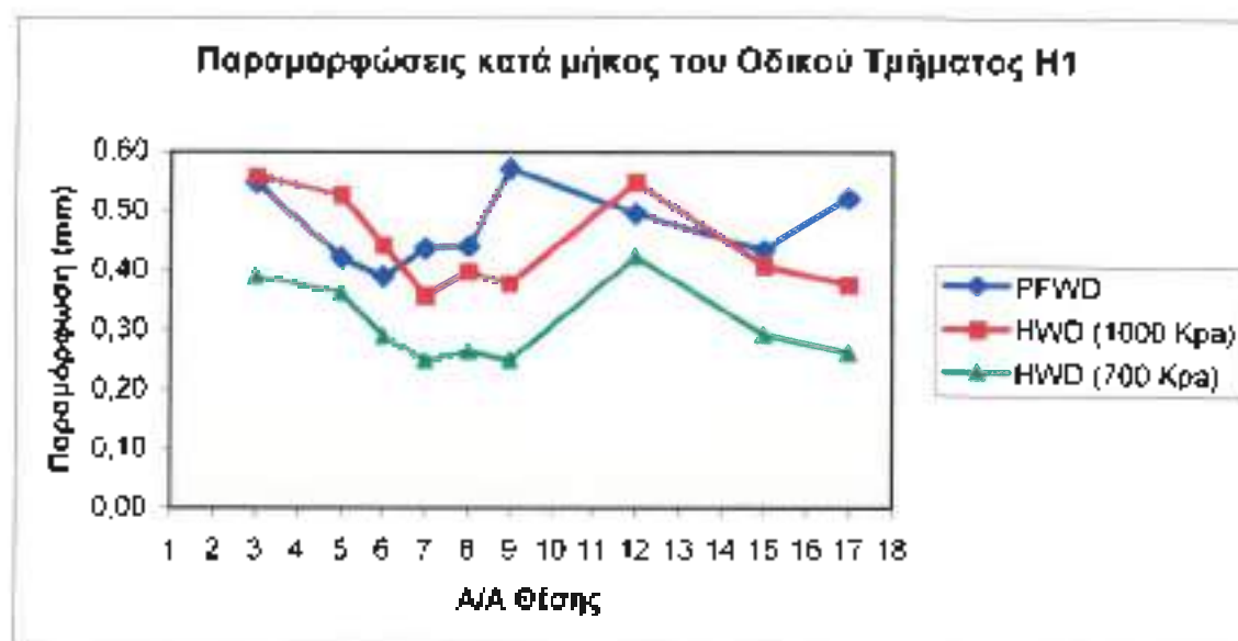
Σχήμα 13.7: Παραμορφώσεις κατά μήκος του τμήματος Η1 (Δίκτυο Χαλκιδικής)
