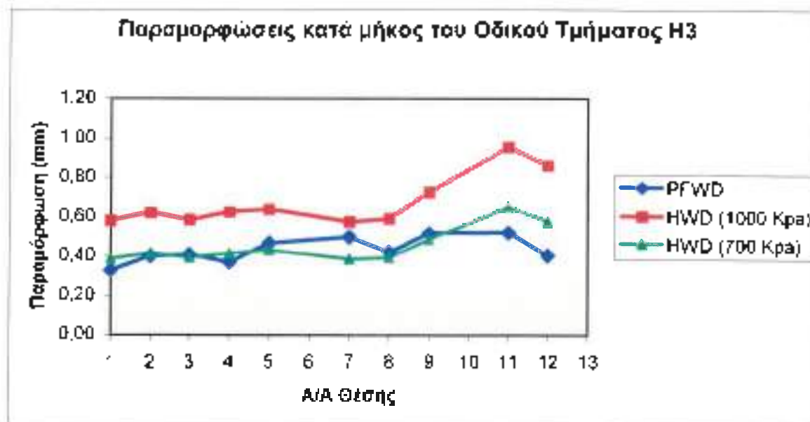
Σχήμα 13.2: Παραμορφώσεις κατά μήκος του τμήματος Η3 (Δίκτυο Χαλκιδικής)
