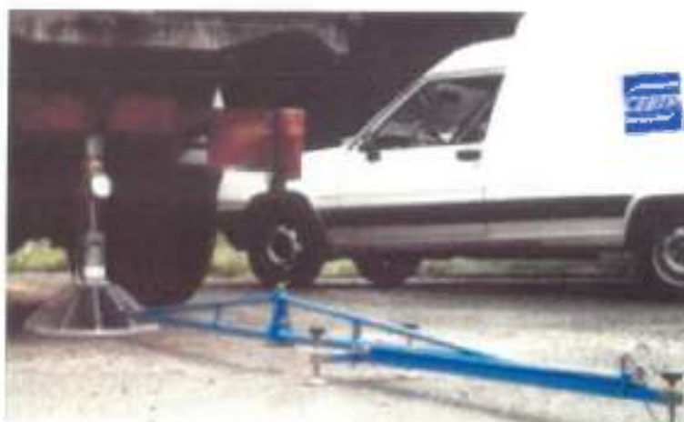
Σχήμα 2.5: Χρήση της Ράβδου Benkelman ( www.cedex.fr/vente/benkelman/benkelman_us.htm )
