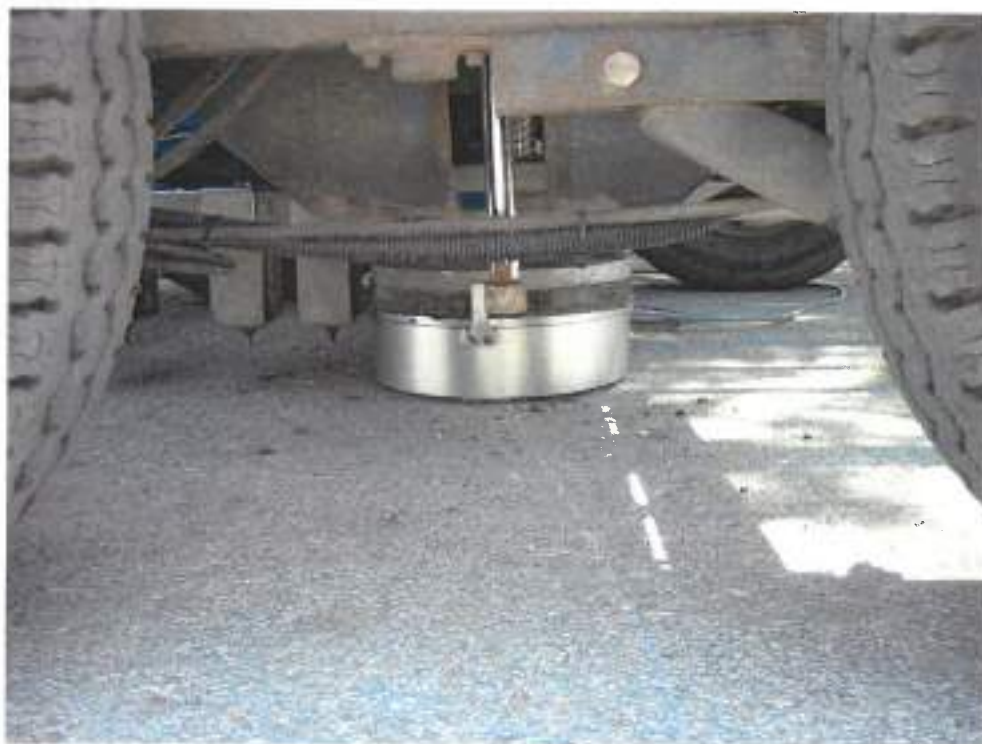
Σχήμα 3.4: Πλάκα Φόρτισης (Φωτογραφία από τις επί τόπου μετρήσεις – Κεφάλαιο 7 ο )
