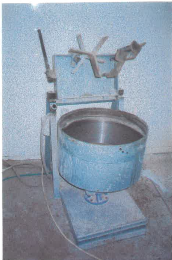
Σχ.17: Ο αναμεικτήρας που χρησιμοποιήθηκε στην παρασκευή δοκιμίων
