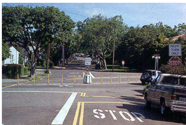
Εικόνα 2.9: Ενδιάμεσο κεντρικό στηθαίο οδού (Πηγή: Ewing, 2000 )
