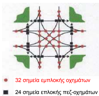
Σχήμα 2.3: πριν τη μετατροπή διασταύρωσης σε κόμβο (Πηγή: Wallwork, 2001)
