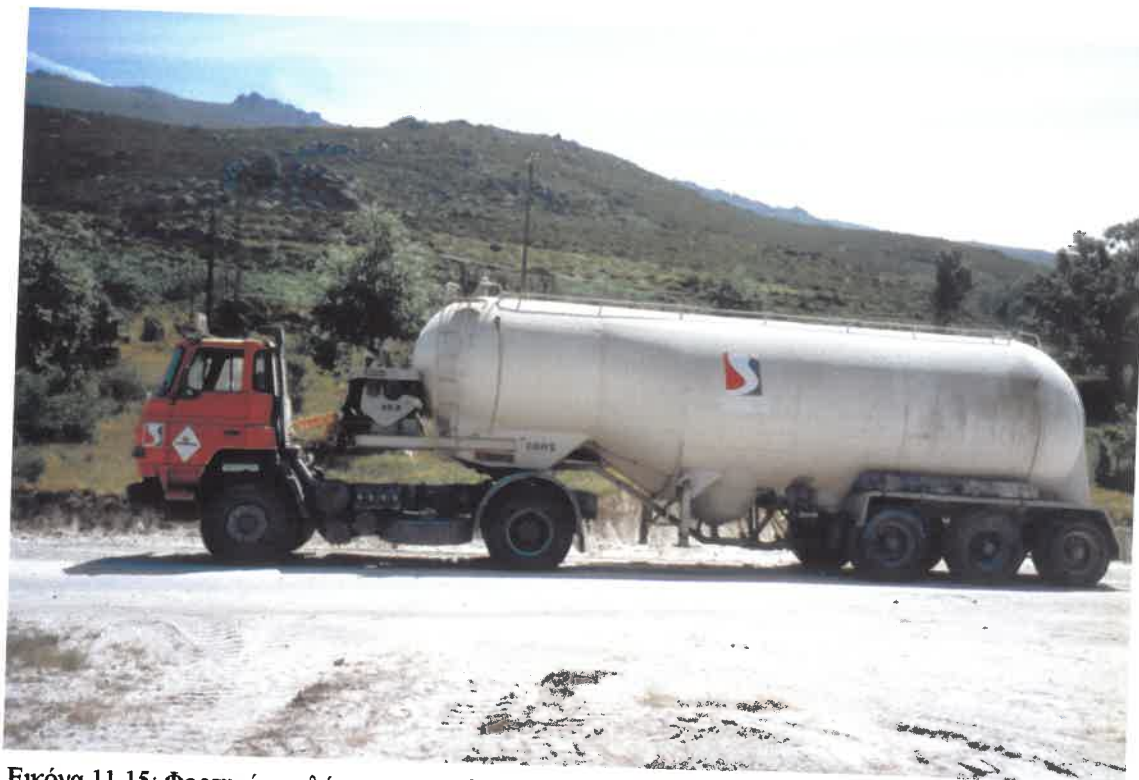
Εικόνα 11.15: Φορητό – σιλό για τον εφοδιασμό τσιμέντου
