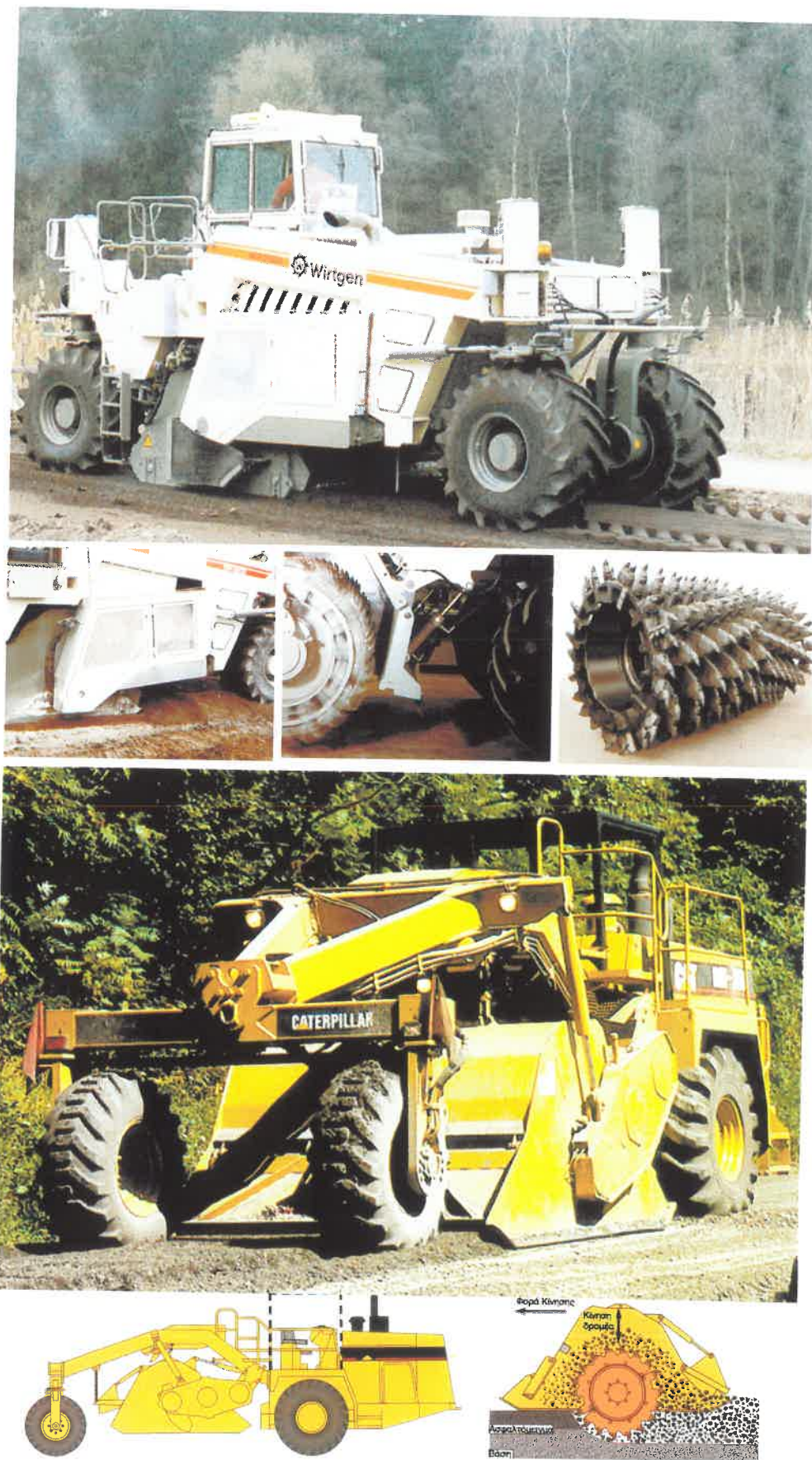
Εικόνα 7.4: Δύο τύποι ανακυκλωτήρων (Wirtgen, Caterpillar), προερχόμενοι από μηχανές σταθεροποίησης εδαφών και λεπτομέρειές τους.
