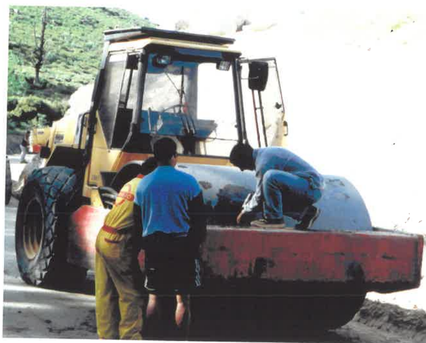
Εικόνα 11.34: Καθαρισμός του κυλίνδρου του δονητικού οδοστρωτήρα από κομμάτια γαλακτώματος που έχουν προσκολληθεί σε αυτό.
