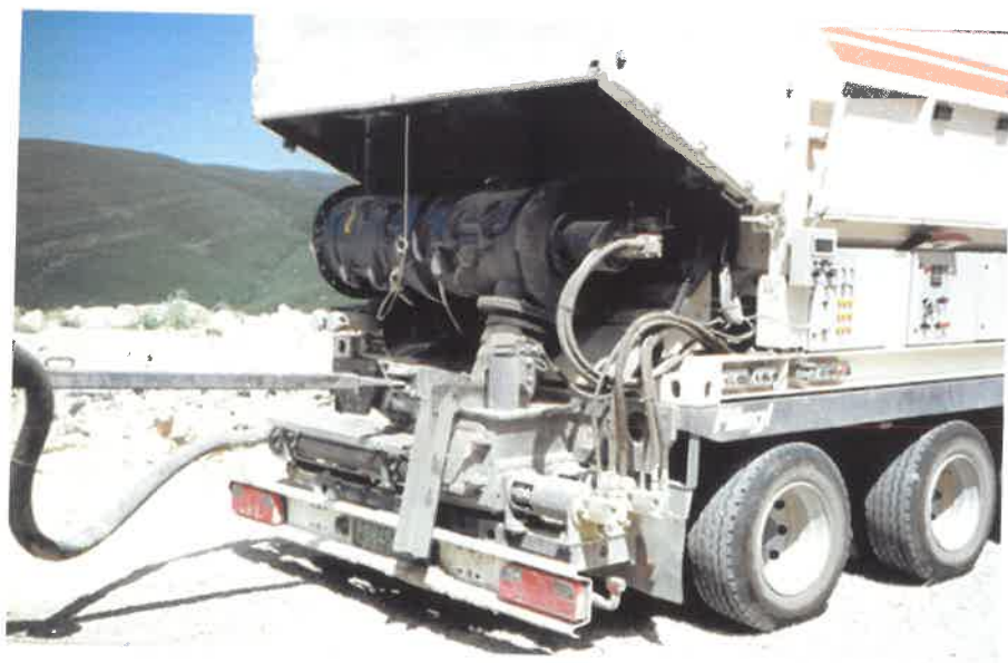
Εικόνα 11.21: Ηλεκτρονικός υπολογιστής που βρίσκεται στο πίσω και πλαϊνό μέρος του μηχανήματος. Φαίνεται ο αναμικτήρας τσιμέντου και νερού (στο πίσω τμήμα του μηχανήματος)
