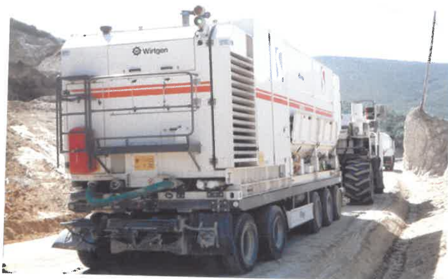
Εικόνα 11.20: Διανεμητήρας τσιμέντου σε μορφή γαλακτώματος. Φαίνεται το πράσινο και κόκκινο φως στο πάνω, δεξί, πίσω μέρος του, ενδεικτικό της ποσότητας του τσιμέντου που έχει απομείνει στο μηχανήμα. Δίπλα: Σωλήνας ένδειξης της στάθμης του νερού που απομένει στο μηχανήμα
