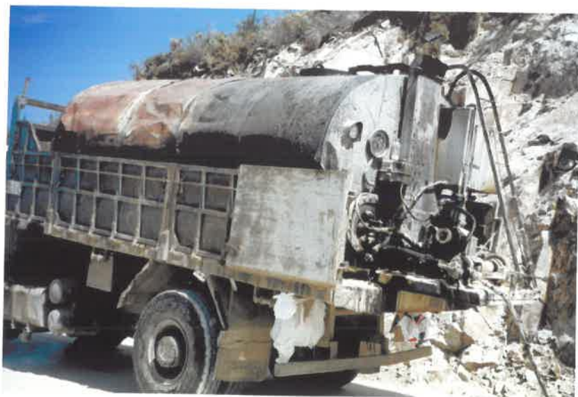
Εικόνα 11.35: Βυτιοφόρο γαλακτώματος συντήρησης
