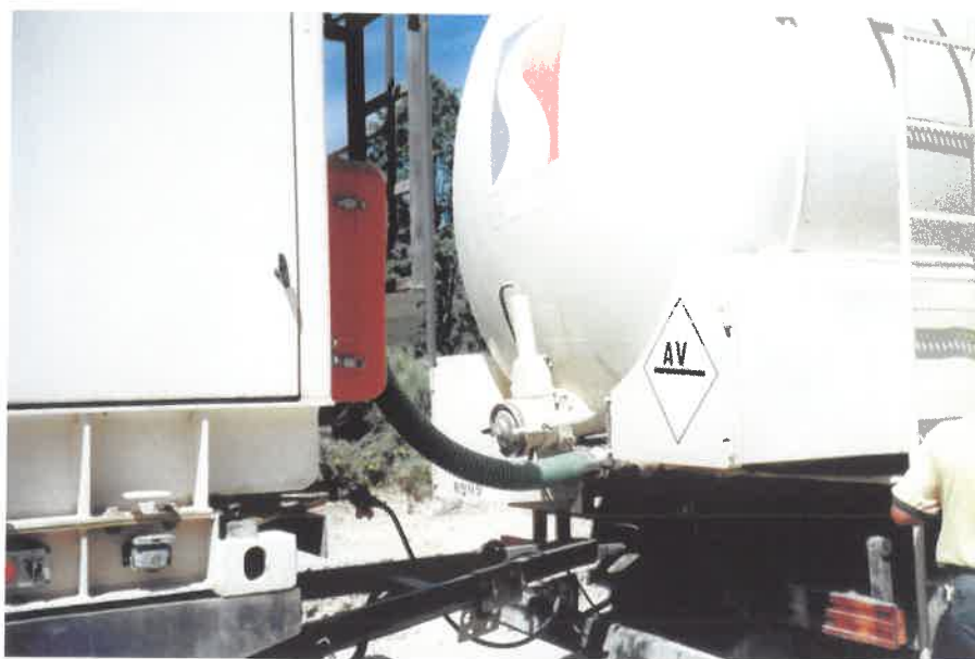
Εικόνα 11.19: Λεπτομέρεια της διαδικασίας εφοδιασμού νερού
