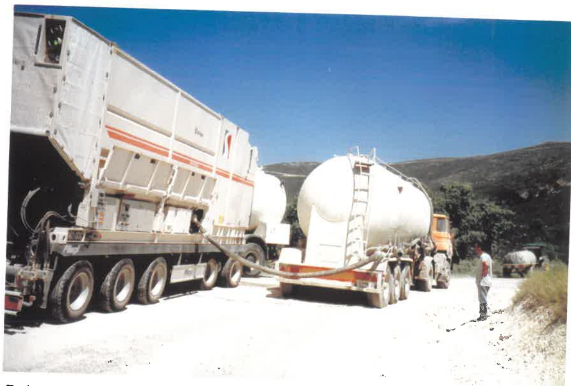
Εικόνα 11.16: Εφοδιασμός τσιμέντου (σε σκόνη), με τη βοήθεια αντλίας αέρα υπό πίεση 1Atm
