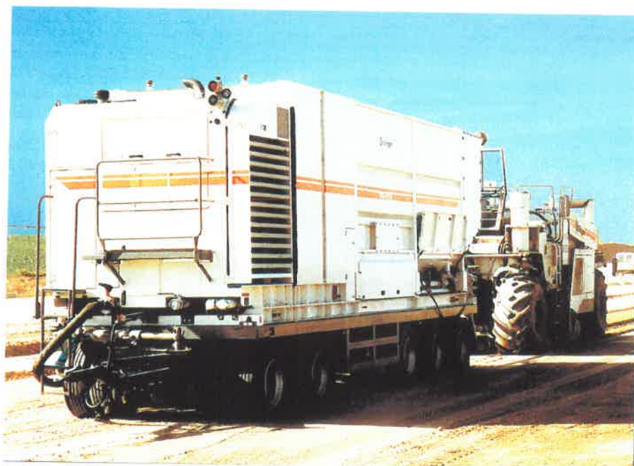
Εικόνα 7.3. Μηχανή διανομής του τσιμέντου σε μορφή γαλακτώματος αποφεύγοντας τη διάχυση σκόνης τσιμέντου στο περιβάλλον
