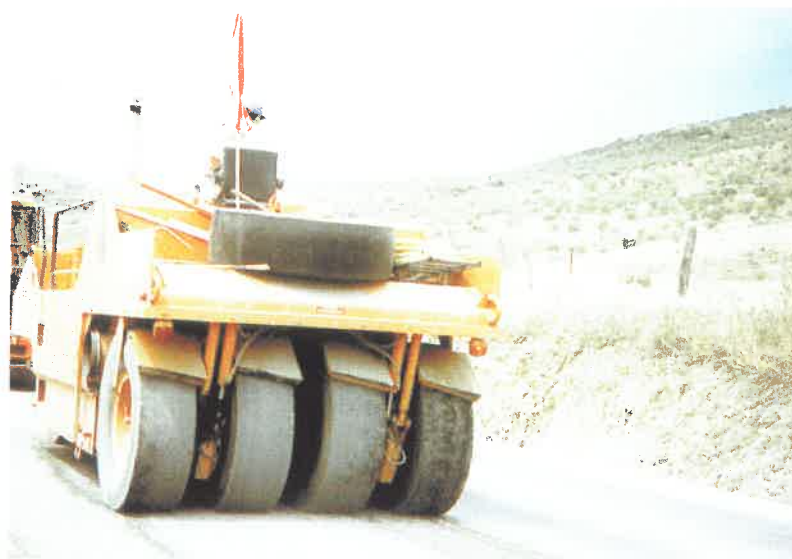
Εικόνα 7.8: Δύο τύποι οδοστρωτήρων. Κάτω: Ελαστικοφόρος Πάνω: Δονητικός με λείους τροχούς.
