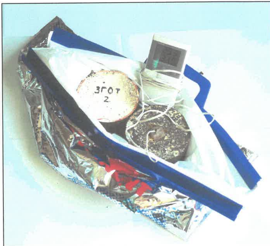
Εικόνα 2.3-5 Μεταφορά δοκιμίου με ισοθερμική σακούλα
