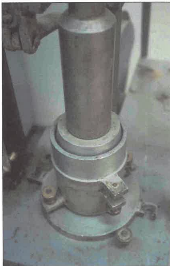
Εικόνα 2.3-4 Λεπτομέρεια μήτρας δοκιμίου Marshall
