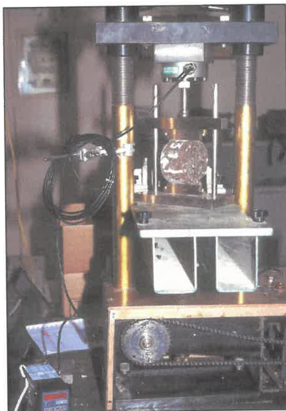
Εικόνα 2.4-7 Συσκευή επιβολής αντιδιαμετρικής θλίψης
