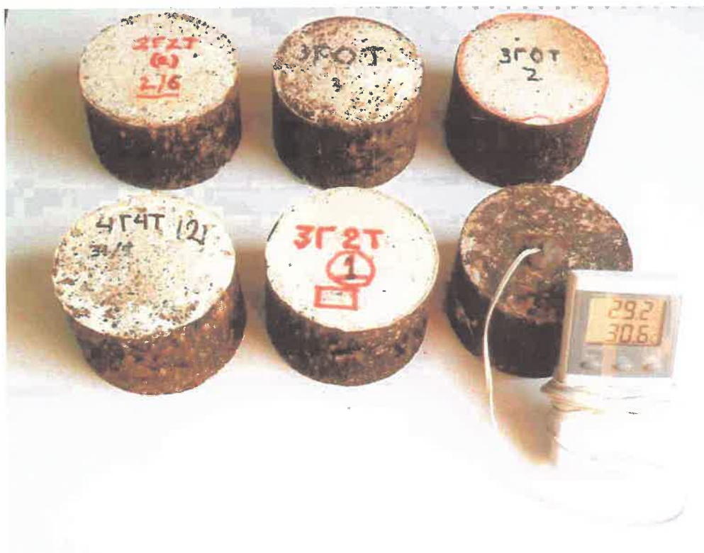
Εικόνα 2.3-6 Δοκίμιο Μάρτυρας (Κάτω δεξιά)
