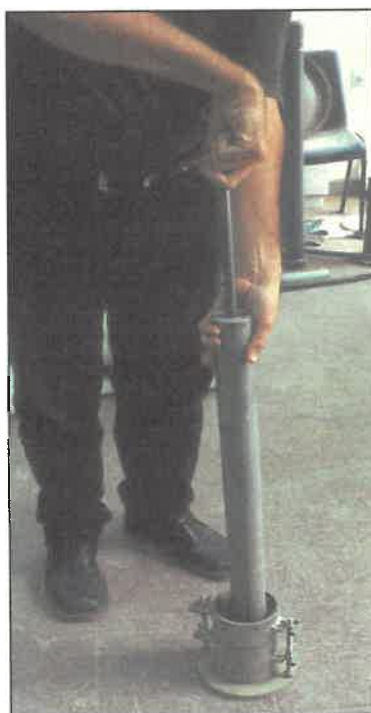
Εικόνα 2.3-1 Συμπύκνωση κατά την τροποποιημένη δοκιμή Proctor
