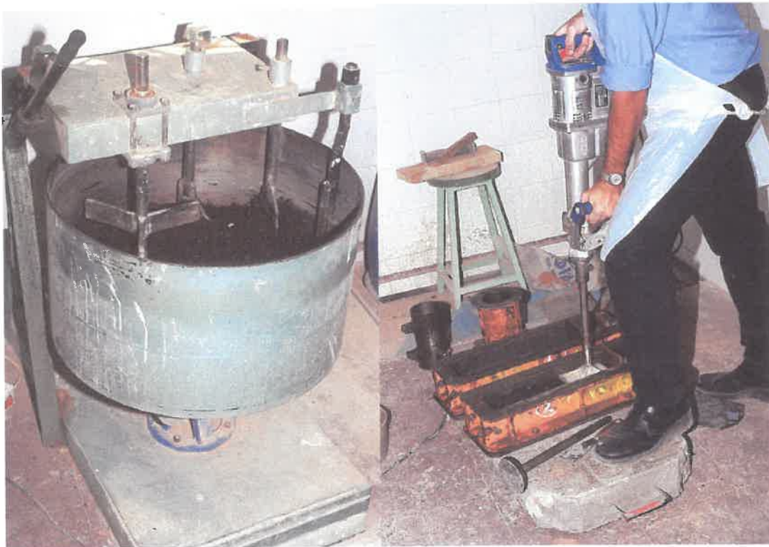
Εικόνα 2.3-10 Συμπύκνωση με ηλεκτρόσφυρα
