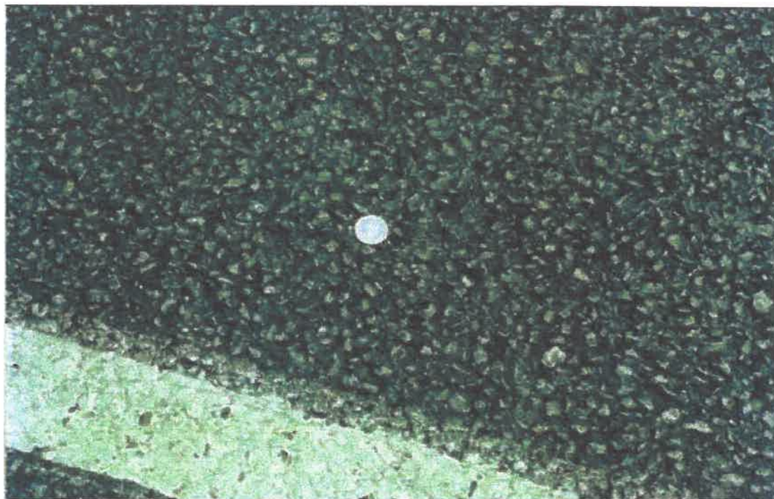
Σχήμα 3.3 Επιφάνεια SMA (λεπτομέρεια) (Brown et all, 1997)
