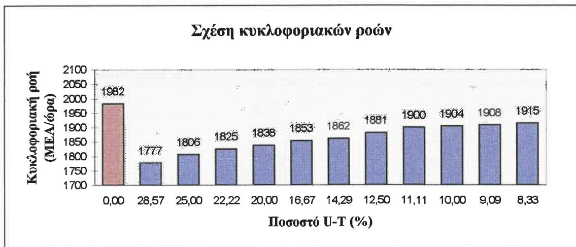
Σχήμα 4.18 : Ιστόγραμμα που απεικονίζει τις διάφορες τιμές κυκλοφοριακής ροής, ανάλογα με το ποσοστό αναστροφών και η σχέση τους με τη ροή κορεσμού, στην πρόσβαση 1. (Λεωφόρος Μεσογείων)
