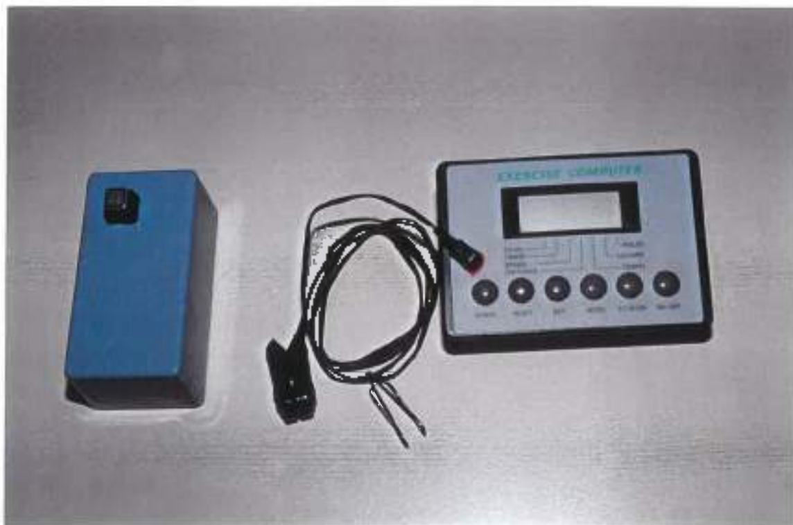
ΦΩΤ.5: Η συσκευή καταγραφής των καρδιακών παλμών και το beeper.
