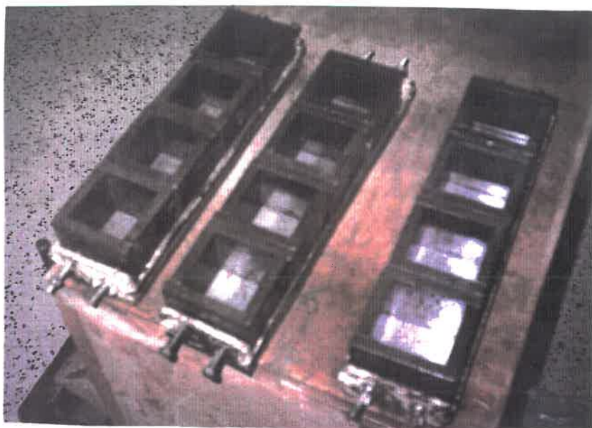
Εικόνα 6.2. Κυβικές μήτρες 7 cm
