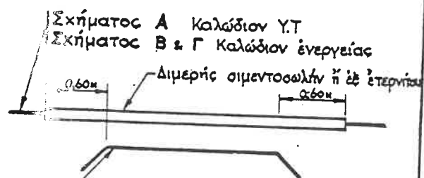
Σχήματος Α Καλώδιον Υ.Τ Σχήματος Β & Γ Καλώδιον ένεργείας Διμερής σιμεντοωλήν ή έξ έτερνίου Σχήματος Α Καλώδιον Χ.Τ Σχήματος Β Καλώδιον άσθενών ρευμάτων Σχήματος Γ Σωλήν ύδατος, φωταερίου κλ. ΚΑΤΟΨΙΣ ΣΧ. Α.Β. & Γ.
