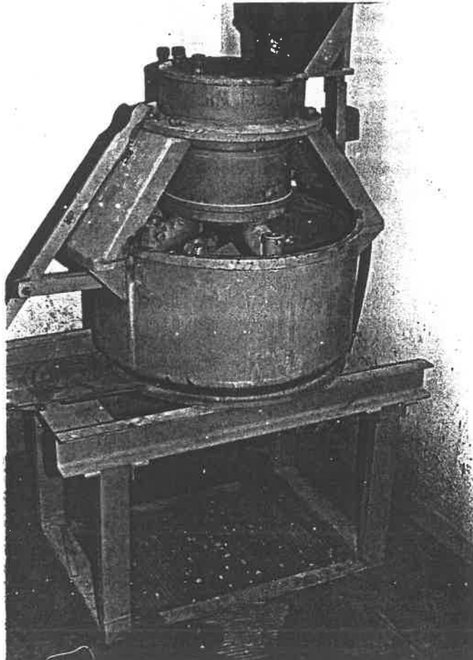
Φωτ. 2. Συσκευή ανάμιξης υλικών για την κατασκευή σκυροδέματος
