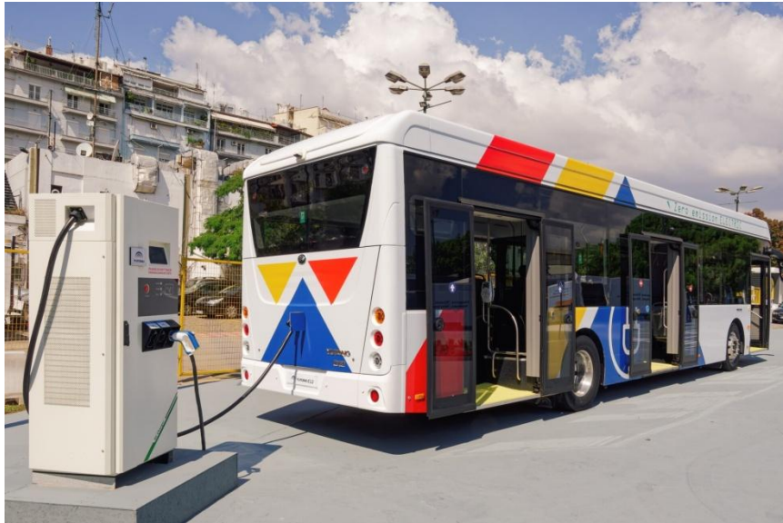
Εικόνα 3: Ηλεκτρικό λεωφορείο μπαταρίας σε διαδικασία φόρτισης σε αστικό σταθμό φόρτισης.
