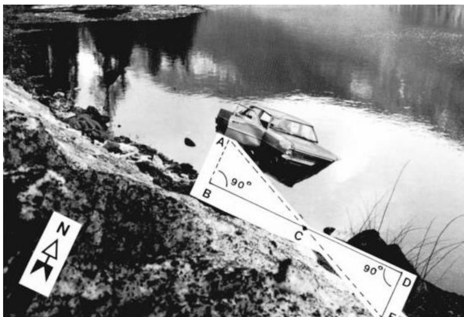
Σχήμα 2.1 : Απεικόνιση μεθόδου ειδικής περίπτωσης όπου όχημα εξετράπη της πορείας του και κατέληξε σε μη προσβάσιμο σημείο (R. W. Rivers, 2011)
