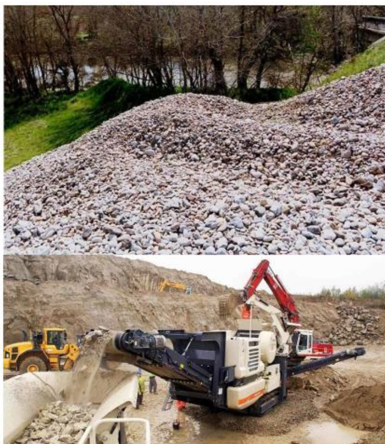
Εικόνα 2.6: Συλλεκτά αδρανή (άνω) και θραυστά αδρανή (κάτω)
