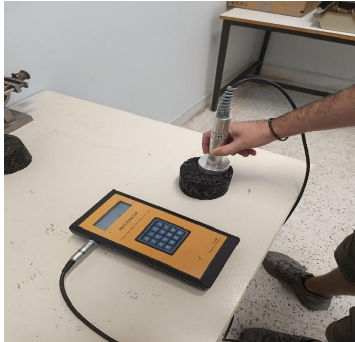
Εικόνα 4.5: Διαδικασία μέτρησης της διηλεκτρικής σταθεράς
