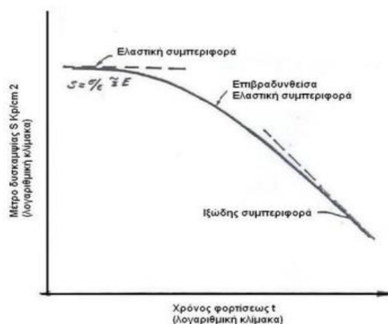
Εικόνα 2.13: Σχέση μέτρου δυσκαμψίας ασφαλτομίγματος-διάρκεια φόρτισης Πηγή: (Λοΐζος, Α. & Πλατή, Χ., 2021b)
