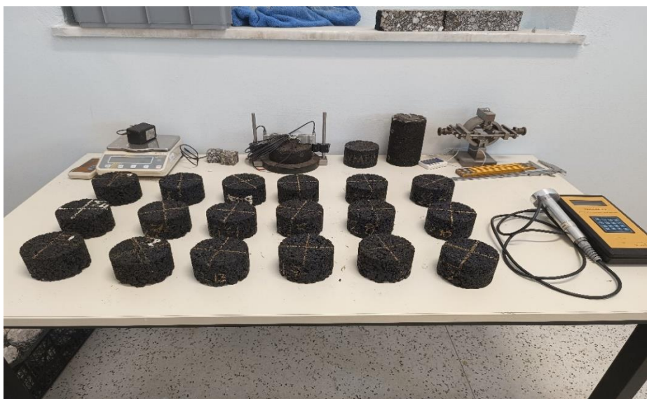
Εικόνα 4.2: Δοκίμια Marshall – Σκωρία
