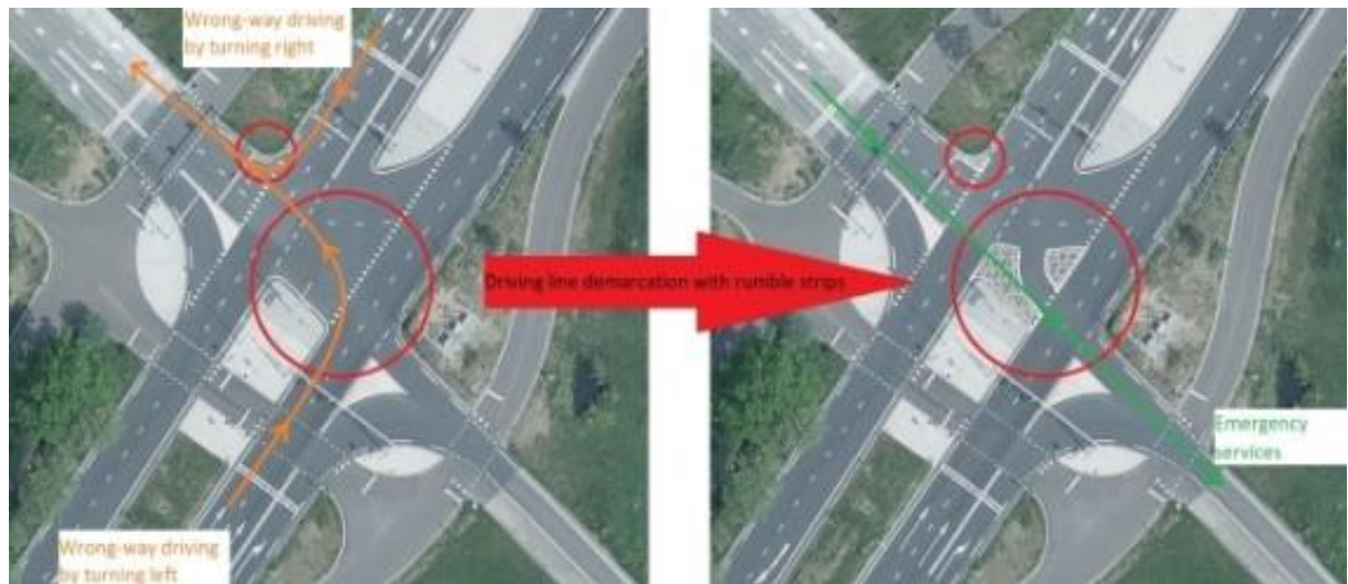
Εικόνα 2.36 Παράδειγμα οριοθέτησης γραμμών οδήγησης – ΟΛΛΑΝΔΙΑ [7].
