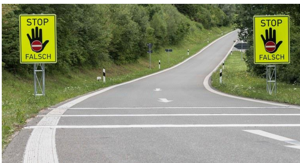
Εικόνα 2.43 Συνδεδημένοι κλάδοι εισόδου και εξόδου με εμφανή σήμανση – ΓΕΡΜΑΝΙΑ [12].
