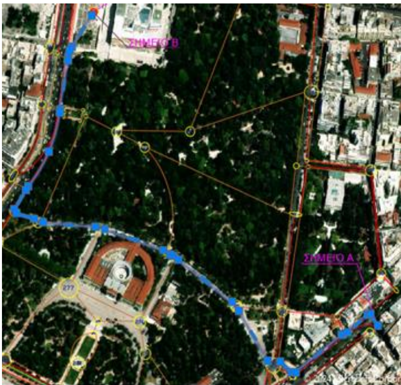
Εικόνα 6.5.3: Βέλτιστη διαδρομή για ελαχιστοποίηση κίνησης αντίθετα των οχημάτων, κλίσης δρόμου, μέσης ταχύτητας οχημάτων και μεγιστοποίησης ευρύτητας πεζοδρομίου.
