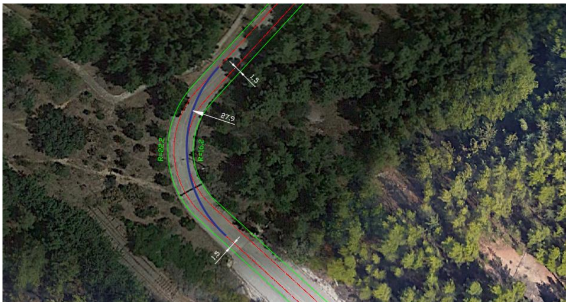
Σχήμα 10.8. Γεωμετρικός προσδιορισμός της ακτίνας στροφής του οχήματος.
