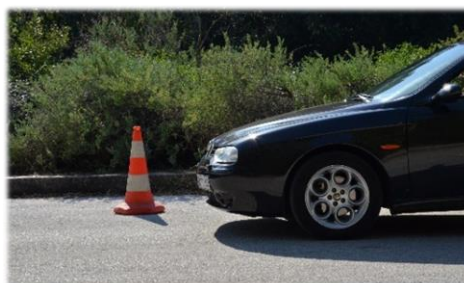
Σχήμα 10.10. Δοκιμή πλήρους ευθύγραμμης πέδησης μέχρι ακινητοποιήσεως - λήψη συντελεστή f_T .
