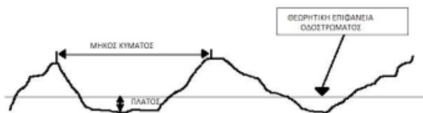
Εικόνα 3.3 Κύρια στοιχεία κυματισμών επιπεδότητας (S. H. Cardoso, 2002)
