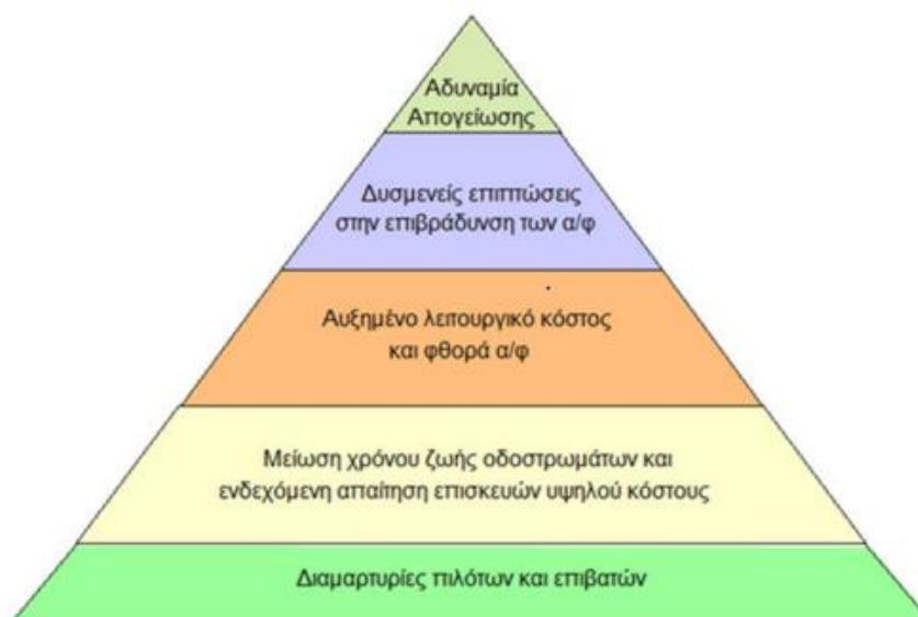
Εικόνα 3.1 Συνέπειες έλλειψης ομαλότητας στα οδοστρώματα αεροδρομίων (Λοΐζος, Πλατή, 2014)
