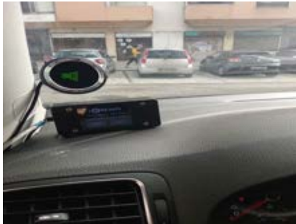
Εικόνα 4.2: Εξοπλισμός ανατροφοδότησης πληροφοριών σε πραγματικό χρόνο στο παρμπρίζ του αυτοκινήτου
