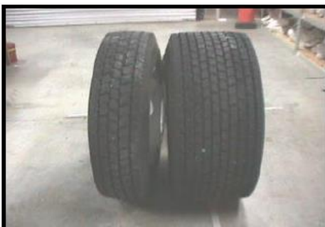
Εικόνα 3.14: Σύγκριση μεγέθους μεταξύ ενός ελαστικού από τη σύνθεση διπλών ελαστικών και της νέας γενιάς μονών πλατύπελμων ελαστικών (Al - Qadi, et al., 2009)
