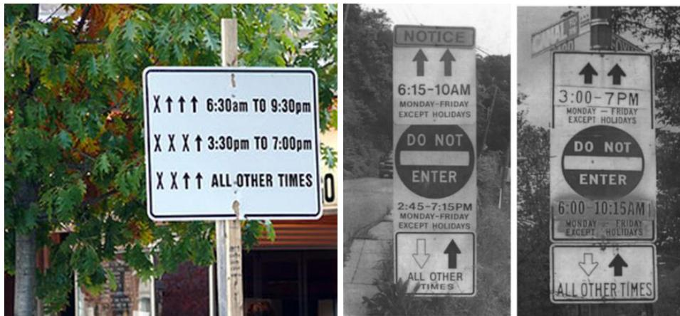
Εικόνα 1: Παραδείγματα στατικά εναλλασσόμενων λωρίδων κυκλοφορίας
