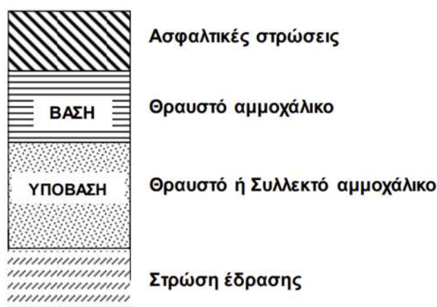
Εικόνα 3.1: Διατομή εύκαμπτου οδοστρώματος
