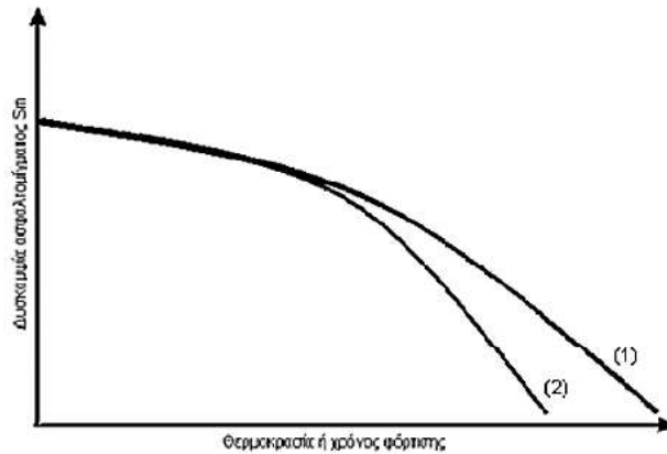
Εικόνα 2.1 Αναπαράσταση της εξάρτησης της δυσκαμψίας του οδοστρώματος από τη θερμοκρασία και το χρόνο φόρτισης
