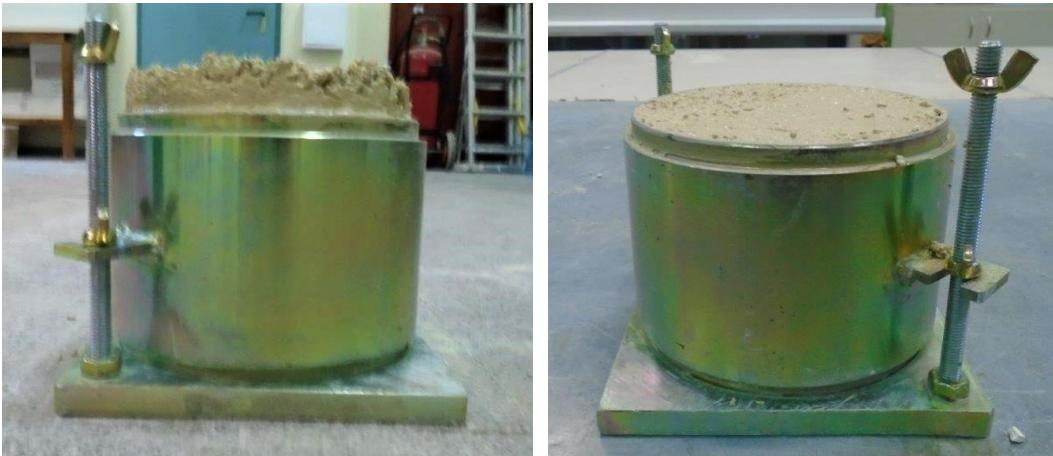
**Εικόνα 4.2** Αριστερά φαίνεται η μήτρα με το δοκίμιο μετά την αφαίρεση του παρεμβλήματος και δεξιά φαίνεται η μήτρα με το δοκίμιο αφού το υλικό επιπεδωθεί (Φωτογραφίες από το Εργαστήριο Οδοποιίας του ΕΜΠ)
