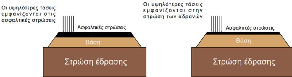
**Εικόνα 2.5 Δομή οδοστρώματος υψηλής κυκλοφορίας (HVR) (αριστερά) και χαμηλής κυκλοφορίας (LVR) (δεξιά)**
