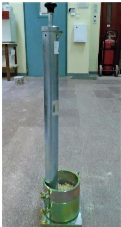
**Εικόνα 5.9** Διάταξη δοκιμίου κατά τη δοκιμή συμπύκνωσης. Εδώ φαίνονται η μήτρα και ο κόπανος που χρησιμοποιήθηκαν στο εργαστήριο (Φωτογραφία από το Εργαστήριο Οδοποιίας του ΕΜΠ)
