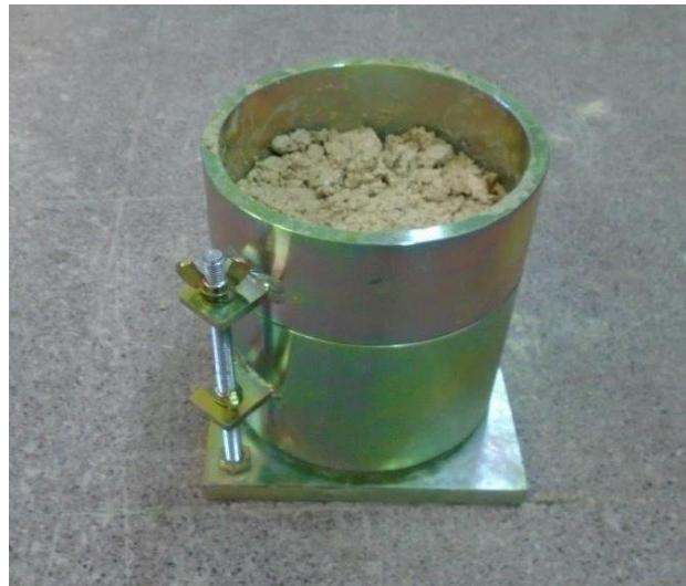
**Εικόνα 4.1 Δοκίμιο μέσα στη μήτρα που χρησιμοποιείται στη δοκιμή συμπύκνωσης (Φωτογραφία από το Εργαστήριο Οδοποιίας του ΕΜΠ)**
