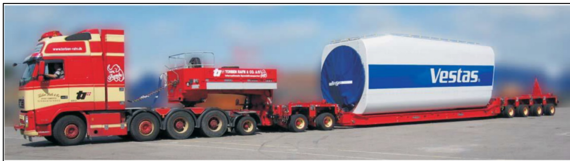
Εικόνα 3.8: Οχήμα μεταφοράς ατράκτου (πηγή: Wind power engineering and development)
