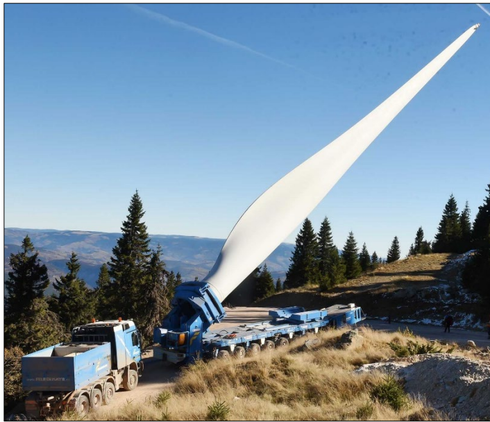
Εικόνα 3.13: Πλατφόρμα ανύψωσης πτερυγίου (πηγή: Felbermayr)
