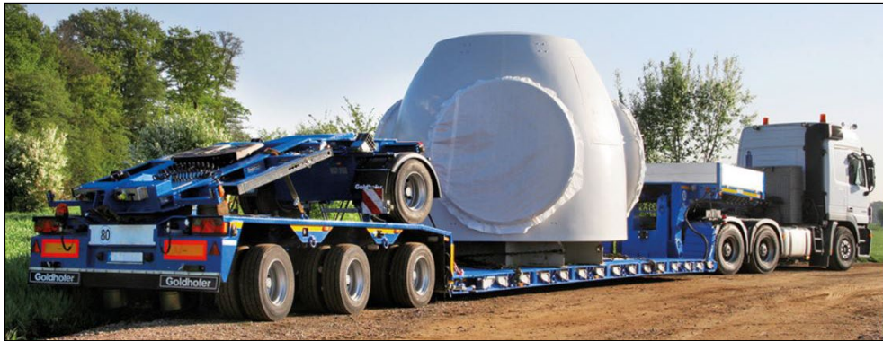
Εικόνα 3.7: Οχήμα μεταφοράς κομματιού διασύνδεσης πτερυγίων (πηγή: Goldhofer)
