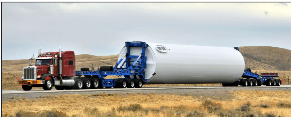
Εικόνα 3.9: Όχημα μεταφοράς πύργου (πηγή: Engineering.com)
