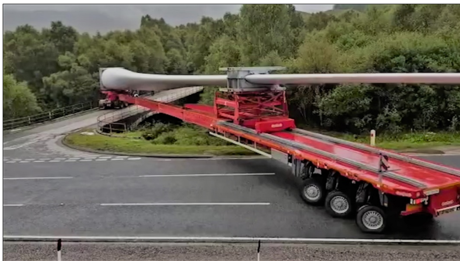
Εικόνα 3.11: Πλατφόρμα απλού τύπου (πηγή: CNN)
