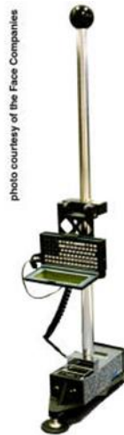
Εικόνα 2.11. Συσκευή Dipstick ( https://pavementinteractive.org/reference-desk/pavement-management/pavement-evaluation/roughness/ )
