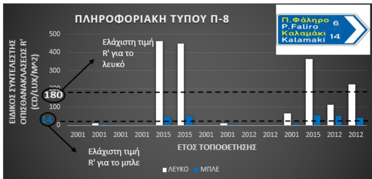
Διάγραμμα 4.17: Ειδικός συντελεστής οπισθανάκλασης ( R' ) για πινακίδες τύπου Π-8 σε παράπλευρες οδούς στη Λ. Ποσειδώνος.
