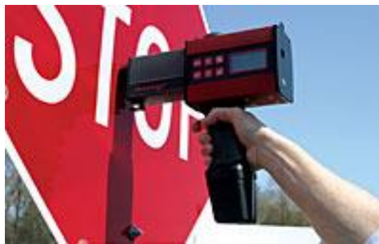
Εικόνα 3.2: Μέτρηση αντανάκλαστικότητας σε πινακίδα σήμανσης με το Retrosign GR3 [Πηγή: https://roadsensors.madebydelta.com ]
