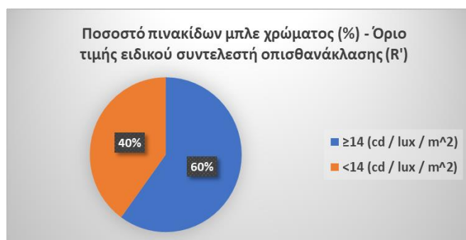
Διάγραμμα 4.24: Κατανομή πινακίδων σήμανσης σε σχέση με την ελάχιστη τιμή του συντελεστή οπισθανάκλασης για το μπλε χρώμα (14 cd/lux/m 2 )
