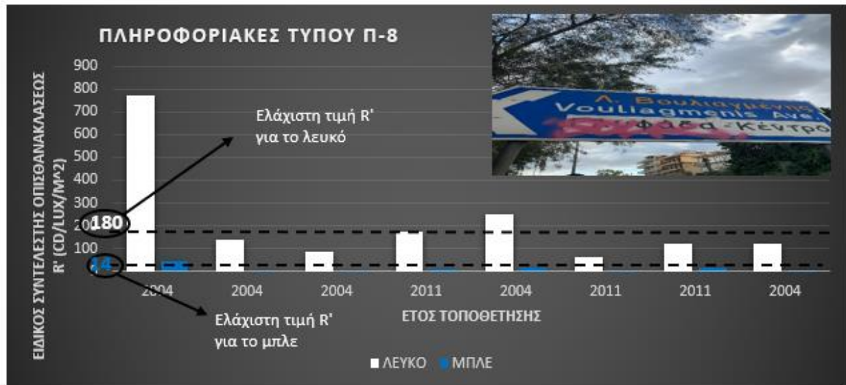
Διάγραμμα 4.16: Ειδικός συντελεστής οπισθανάκλασης ( R' ) για πινακίδες τύπου Π-8 στη Λ. Ποσειδώνος.
