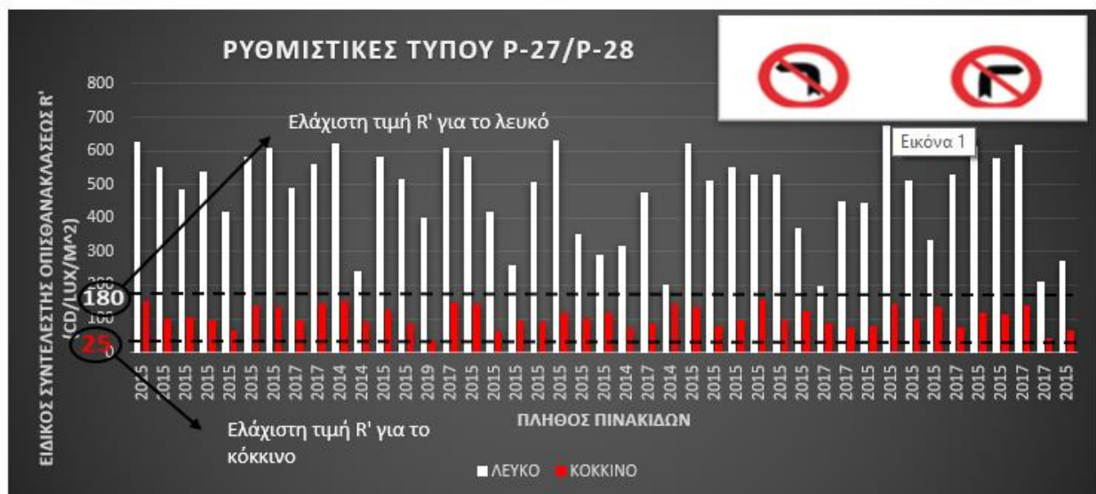
Διάγραμμα 4.6: Ειδικός συντελεστής οπισθανάκλασης ( R' ) για πινακίδες τύπου P-27, P-28 σε παράπλευρες οδούς στη Λ. Ποσειδώνος.
