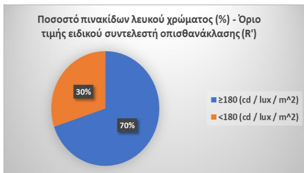
Διάγραμμα 4.22: Κατανομή πινακίδων σήμανσης σε σχέση με την ελάχιστη τιμή του συντελεστή οπισθανάκλασης για το λευκό χρώμα (180 cd/lux/m 2 )
