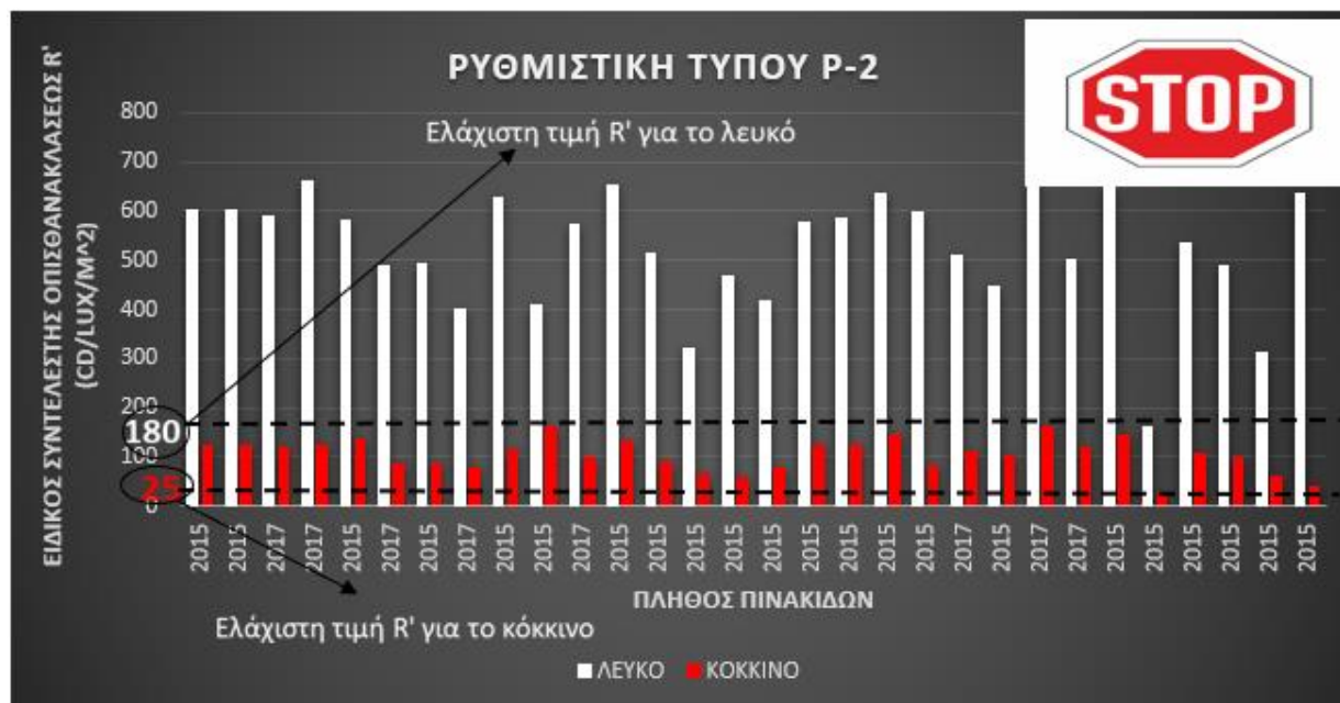
Διάγραμμα 4.3: Ειδικός συντελεστής οπισθανάκλασης ( R' ) για πινακίδες τύπου P-2 σε παράπλευρες οδούς στη Λ. Ποσειδώνος.
