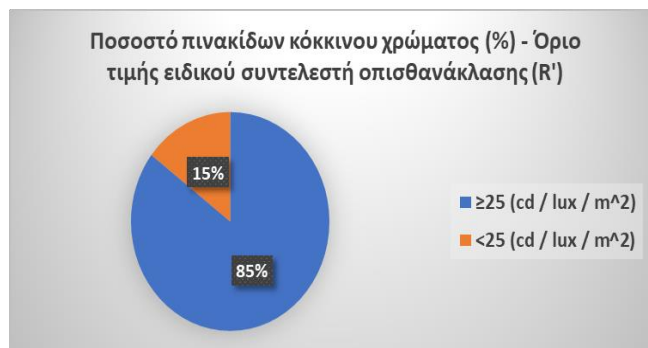
Διάγραμμα 4.23: Κατανομή πινακίδων σήμανσης σε σχέση με την ελάχιστη τιμή του συντελεστή οπισθανάκλασης για το κόκκινο χρώμα (25 cd/lux/m 2 )
