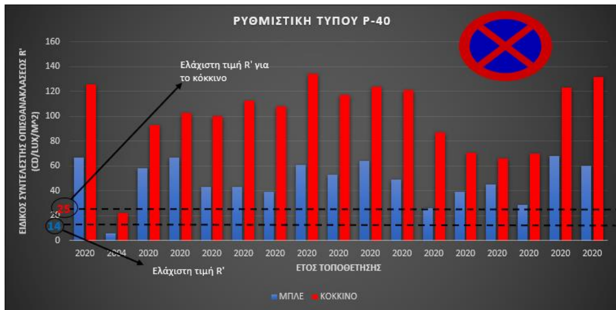
Διάγραμμα 4.9: Ειδικός συντελεστής οπισθανάκλασης ( R' ) για πινακίδες τύπου P-40 στη Λ. Βασιλίσσης Σοφίας.
