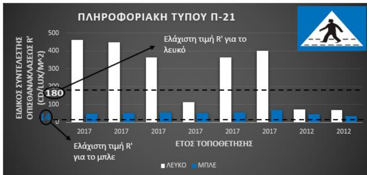
Διάγραμμα 4.14: Ειδικός συντελεστής οπισθανάκλασης ( R' ) για πινακίδες τύπου Π-21 σε παράπλευρες οδούς στη Λ. Ποσειδώνος.
