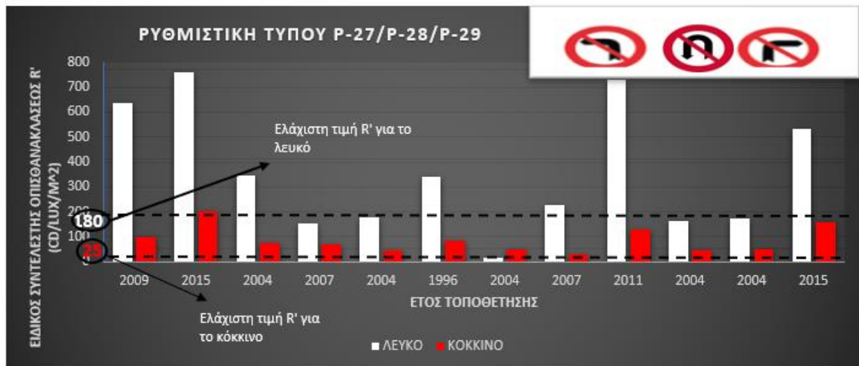
Διάγραμμα 4.5: Ειδικός συντελεστής οπισθανάκλασης ( R' ) για πινακίδες τύπου P-27, P-28, P-29 στη Λ.Ποσειδώνος.
