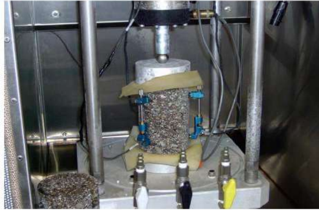
Εικόνα 2.2: Δοκίμιο προετοιμασμένο για δοκιμή (Cross et al. 2007)
