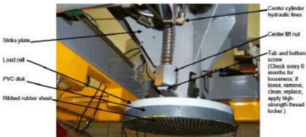
Εικόνα 2.18: Σύνδεση Δυναμοκυψέλης με Κυκλικό Δίσκο Πηγή: (Belt, et al., 2006)
