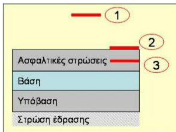
Εικόνα 2.24: Μέτρηση θερμοκρασίας: (1) αέρα, (2) επιφάνειας οδοστρώματος, (3) ασφαλτικών στρώσεων
