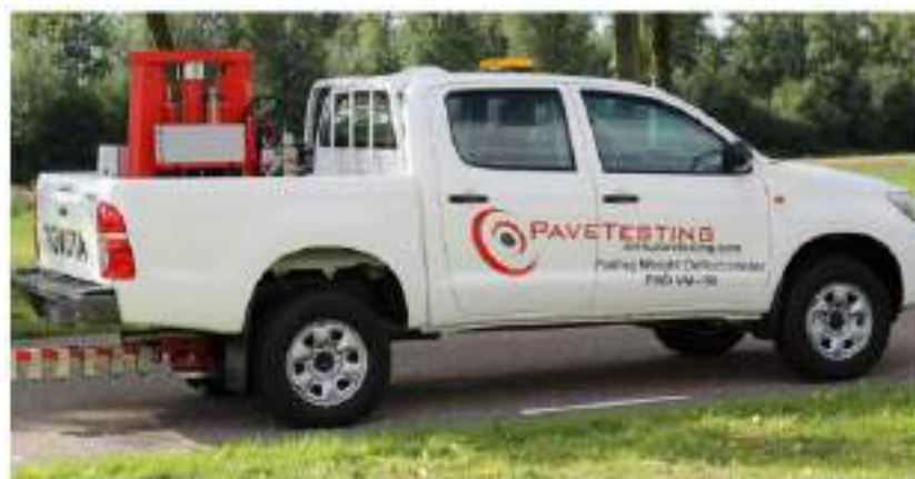
Εικόνα 2.10: FWD ενσωματωμένο σε όχημα Πηγή: (PaveTesting, 2019)
