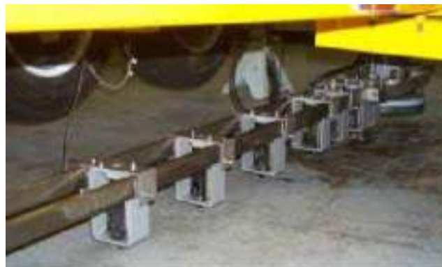
Εικόνα 2.20: Διάταξη γεώφωνων (geophones) Πηγή: (Belt, et al., 2006)
