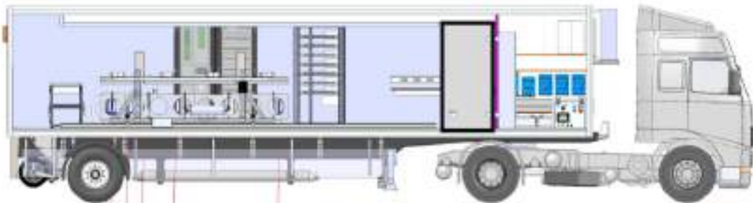
Εικόνα 3.7: Τυπική διαμόρφωση TSD (7 αισθητήρες τεχνολογίας Doppler) Πηγή: (Greenwood Engineering, n.d.)
