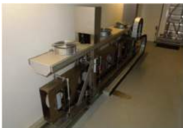
Εικόνα 3.2: Δύσκαμπτη δοκός TSD
