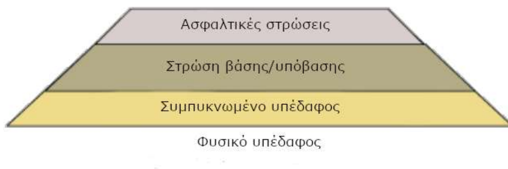
Εικόνα 2.1 Τυπική διατομή εύκαμπτου οδοστρώματος
