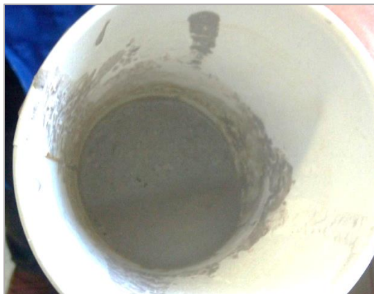
Εικόνα 29. Η παιπάλη που χρησιμοποιήθηκε για την ποσοτικοποίηση των καταλοίπων σε υγρή μορφή (Εργαστήριο Οδοποιίας ΕΜΠ 2019)
