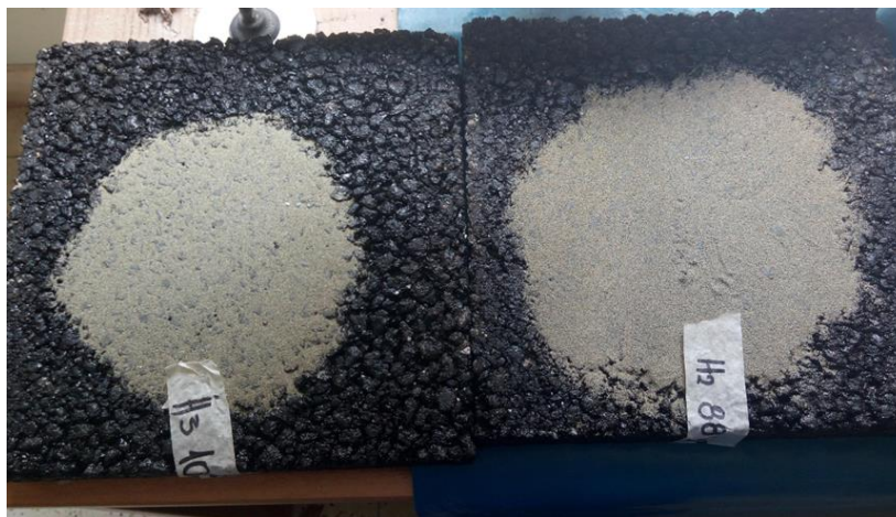
Εικόνα 31. Η διαφορετική διάμετρος της κηλίδας για διαφορετικές πλάκες με διαφορετικά ποσοστά κενών
