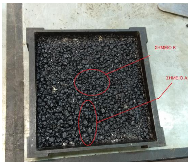
Εικόνα 26. Τα σημεία στα οποία πραγματοποιήθηκαν τα πειράματα (Εργαστήριο Οδοποιίας ΕΜΠ 2019)
