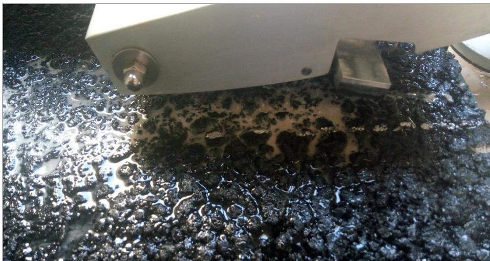
Εικόνα 30. Εργαστηριακή δοκιμή με το BPT (Εργαστήριο Οδοποιίας ΕΜΠ 2019)
