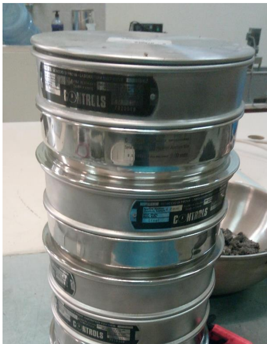
Εικόνα 20. Τα κόσκινα που χρησιμοποιήθηκαν (Εργαστήριο Οδοποιίας ΕΜΠ 2019)
