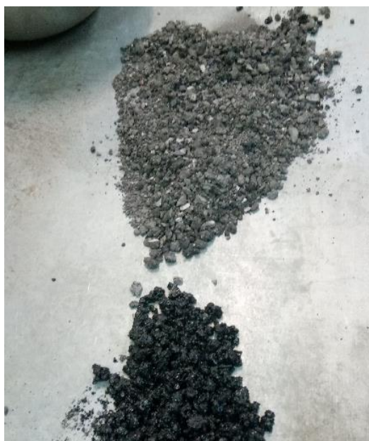
Εικόνα 15. HMA και RAP (Εργαστήριο Οδοποιίας ΕΜΠ 2019)
