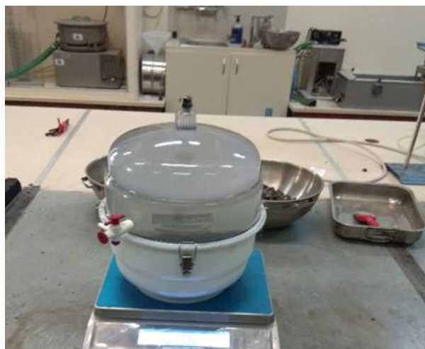
Εικόνα 22. Συσκευή rise (Εργαστήριο Οδοποιίας ΕΜΠ 2019)
