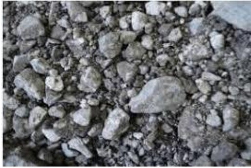
Εικόνα 2. Επαναχρησιμοποιημένο ασφαλτόμιγμα - Reclaimed Asphalt Pavement
