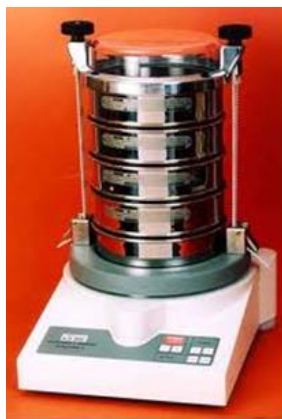
Εικόνα 17. Ηλεκτρονική συσκευή κοσκίνισματος
