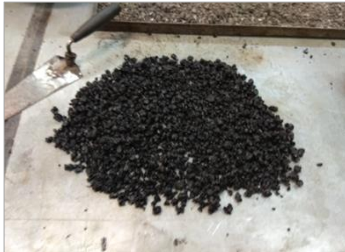
Εικόνα 21. Το μίγμα τετραμερισμένο πριν μπει στο πυκνόμετρο (Εργαστήριο Οδοποιίας ΕΜΠ 2019)
