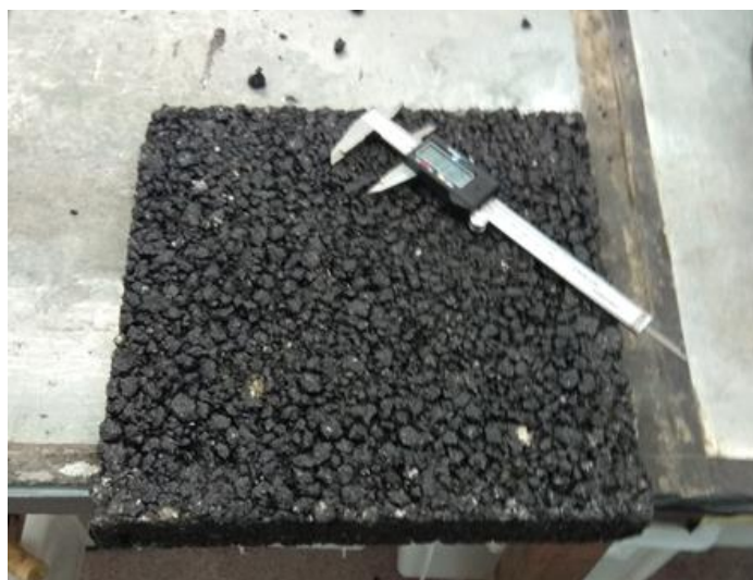
Εικόνα 25. Μέτρηση των διαστάσεων των πλακών (Εργαστήριο Οδοποιίας ΕΜΠ 2019)
