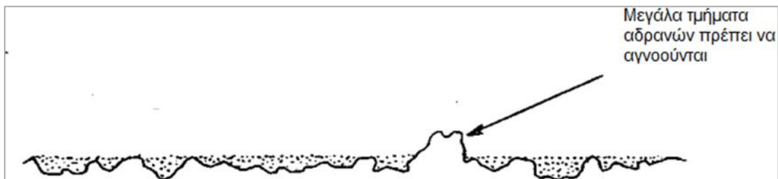
Εικόνα 13. Μετρημένη ποσότητα άμμου τοποθετείται στο οδόστρωμα (Standard test procedure for measurement of texture by the sand method 1981)
