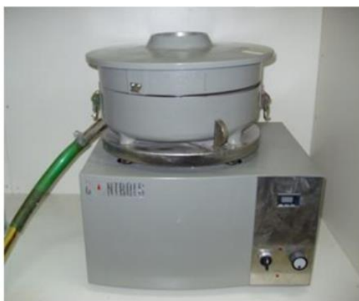
Εικόνα 16. Συσκευή εκχύλισης (Εργαστήριο Οδοποιίας ΕΜΠ 2019)
