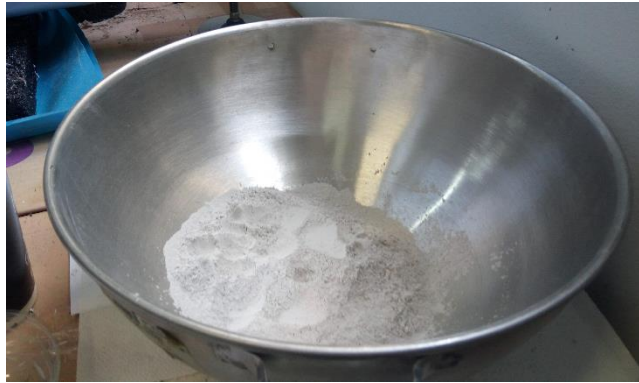
Εικόνα 28. Η παιπάλη που χρησιμοποιήθηκε για την ποσοτικοποίηση των καταλοίπων σε ξηρή μορφή (Εργαστήριο Οδοποιίας ΕΜΠ 2019)
