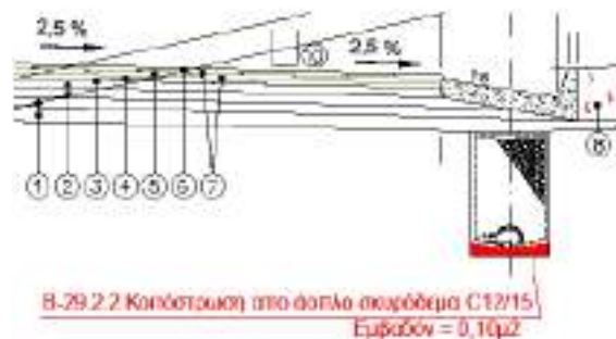
Εικόνα 7.6: Κοιτόστρωση από σκυρόδεμα C12/15
