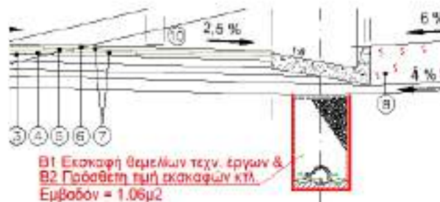
Εικόνα 7.5: Εκσκαφή θεμελίων τεχνικών έργων
