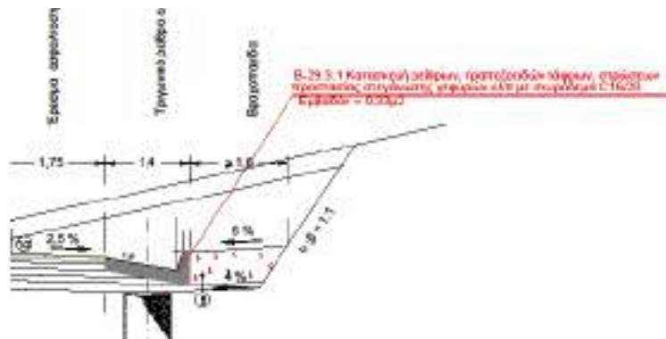
Εικόνα 7.7: Κατασκευή ρείθρων από σκυρόδεμα C16/20
