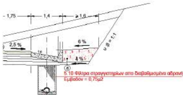
Εικόνα 7.2: Φίλτρα στραγγιστηρίων από διαβαθμισμένα αδρανή
